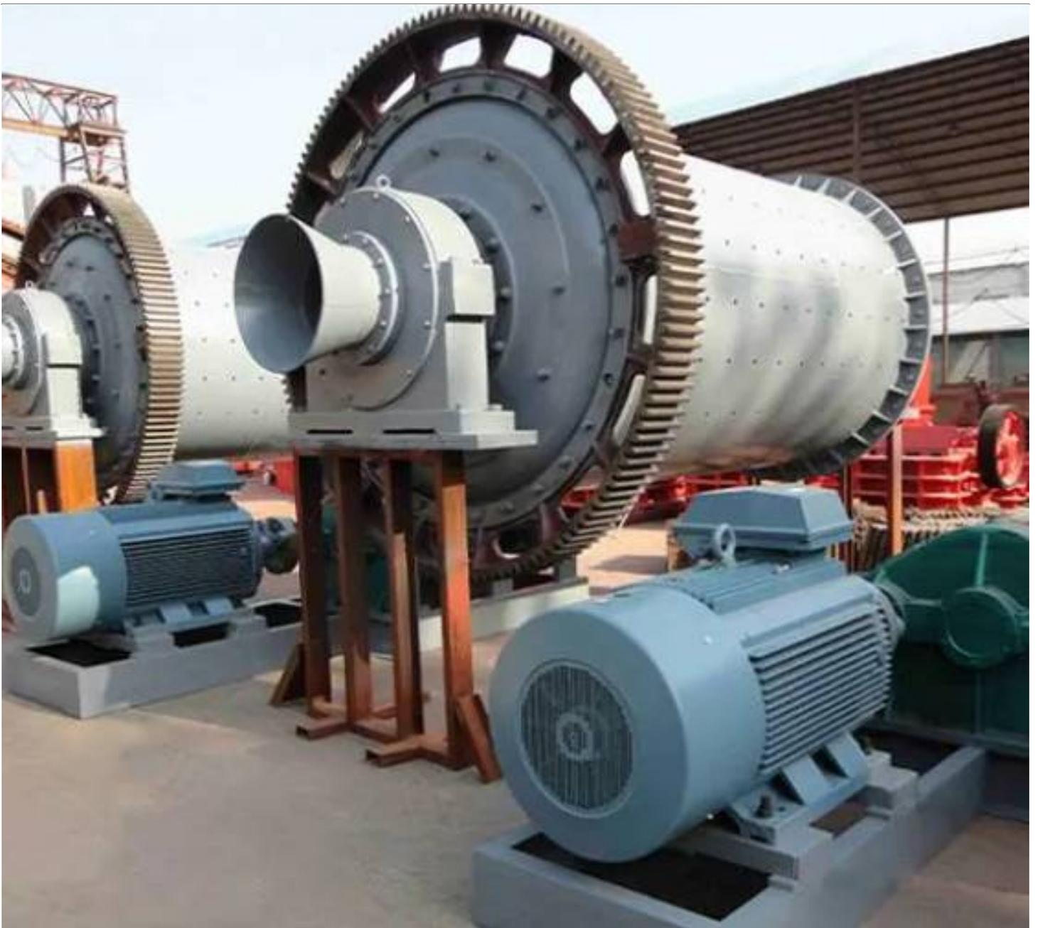
煤磨机是一种专门用于煤粉磨矿的设备。煤磨机可以将煤炭的颗粒研磨至所需尺寸，以满足不同行业对煤粉的需求。煤磨机采用的工作原理与溢流型球磨机相似，通过筒体的旋转和离心力的作用，将煤炭研磨为细小颗粒。煤磨机在电力、冶金、化工等行业中得到了广泛的应用，为煤粉生产和利用提供了有效的设备支持。
