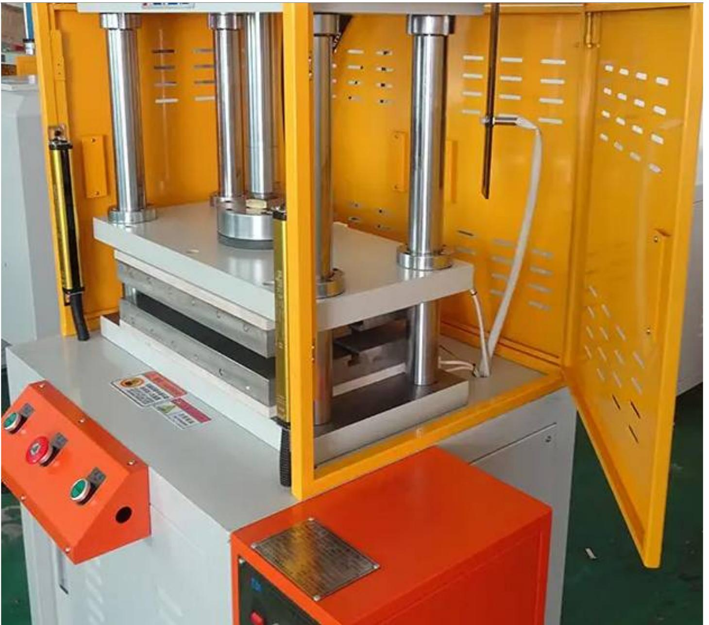
在汽车内饰制造中，螺杆式空气压塑机的应用非常广泛。首先，它可以实现对不同材质塑料的高效压塑，从而满足了汽车内饰对颜色和质感的要求。不同的塑料材料具有不同的特性，如PVC具有较好的可塑性和耐高温性能，而ABS具有较好的耐磨性和机械强度。螺杆式空气压塑机具有快速更换模具的特点，可以灵活地适应不同材料的制造需求。
