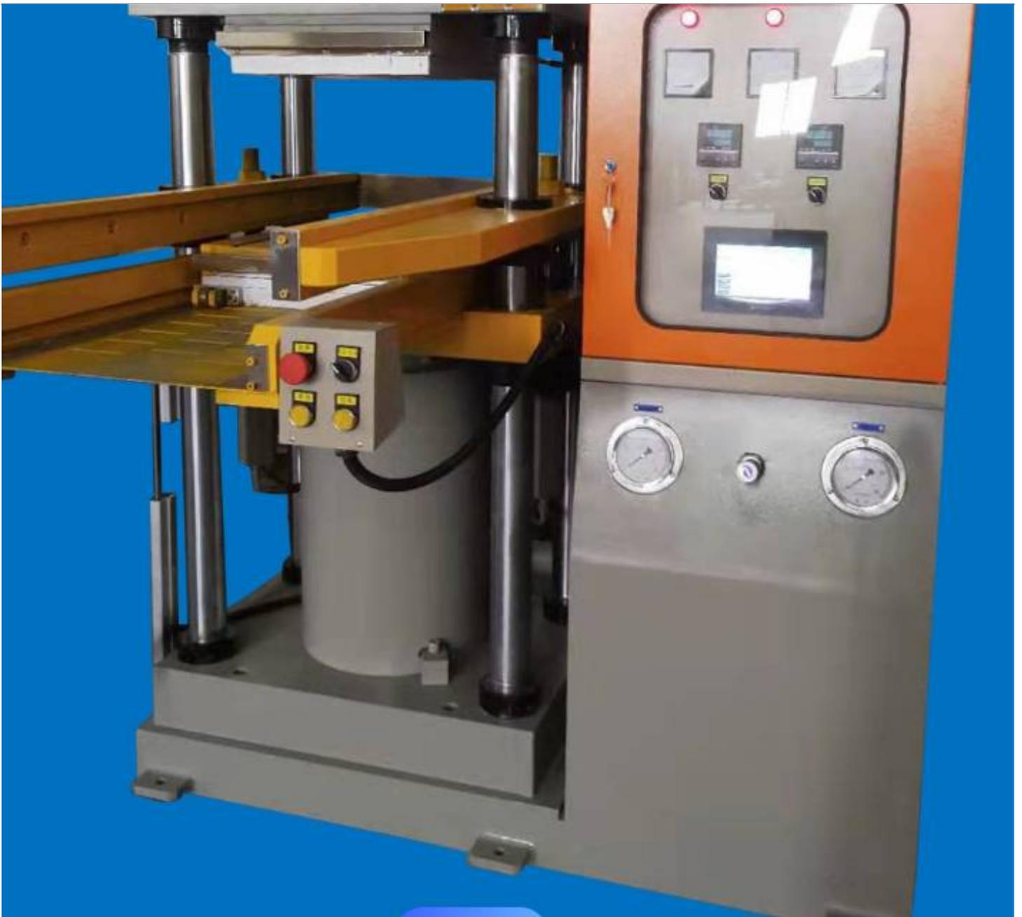
汽车内饰压塑机是一种专门用于汽车内饰制造的设备。它可以将热塑性材料加热到一定温度后，通过模具对材料进行压延成型。汽车内饰压塑机可以生产各种复杂的内饰零件，如仪表盘、门板、座椅等。它具有高生产效率、成本低、产品质量稳定等优点，可以满足汽车制造商对内饰部件质量和产能的要求。同时，汽车内饰压塑机还可以根据不同的需求进行定制化设计，满足客户的个性化需求。
