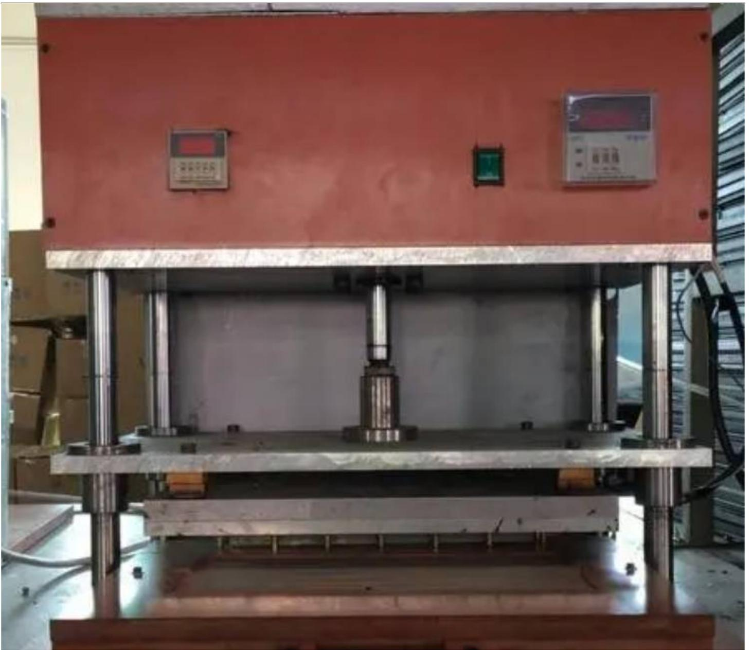
PVC板材是一种常用的建筑材料，具有良好的耐候性、耐化学腐蚀性和电绝缘性。它被广泛应用于室内装修、广告制作、建筑模型制作等领域。PVC板材压塑机是制作PVC板材的关键设备，它能够将PVC原材料加热到一定温度后进行压塑，使其成型成各种规格和形状的板材。这种压塑过程能够增加PVC板材的密度，提高其刚度和强度，使其更适用于各种应用。
