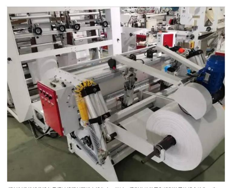
塑料制袋机切袋设备是通过将塑料膜送入设备中,经过一系列传动装置和切割装置的组合动作,完成对塑料膜的切割和造袋操作。根据不同的需求和应用场景,塑料切袋设备可以分为自动切袋设备、半自动切袋设备和手动切袋设备三种类型。自动切袋设备适用于大批量、高效率的包装生产线,半自动切袋设备适用于中小型企业的定制生产,手动切袋设备适用于个体户或小型加工场所。
