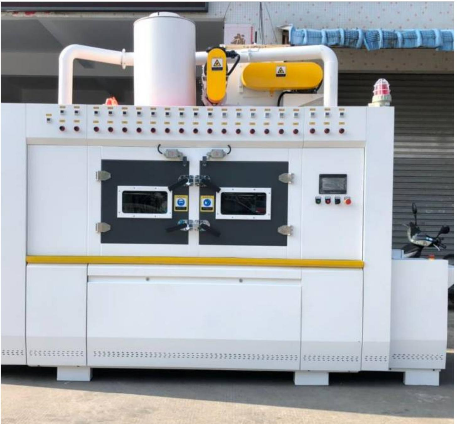
表面处理喷砂机，简称喷砂机，是利用喷砂技术进行表面处理的设备。其工作原理是将磨料通过压缩空气喷射到工件表面，以去除表面的污垢、铁锈、氧化皮等不良物质，从而达到清洁、改善表面质量和增加附着力的效果。
