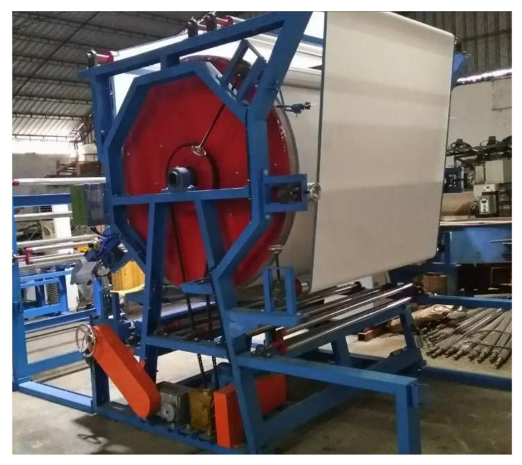
珍珠棉自动粘合机是一种将珍珠棉材料进行粘合的专用设备。它通过高温和压力的作用,将珍珠棉材料熔化并粘合在一起,形成所需的厚度和强度。其工作原理主要包括预热、熔化、冷却和定型四个阶段。预热阶段使珍珠棉材料达到适宜的粘合温度;熔化阶段通过加热头将珍珠棉材料熔化,并传输到压合区域;冷却阶段使珍珠棉材料固化,并形成所需的形状;定型阶段通过定型模具,将珍珠棉材料保持在所需要的形状中。
