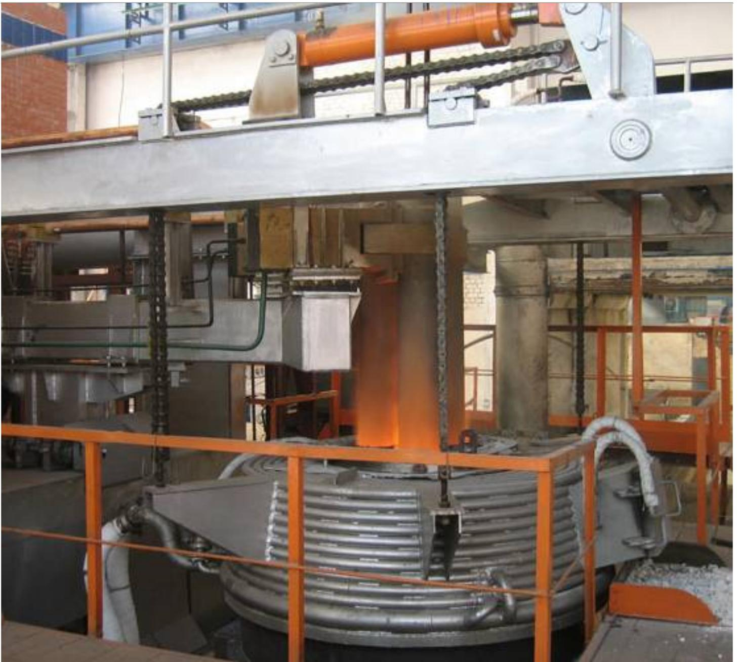
接下来是水冷密封套。水冷密封套是一种用于保护设备的密封系统，通过引入冷却水来降低设备温度，并有效减少能量损耗。在干式选钢渣设备中，水冷密封套的应用可以有效降低设备运行温度，延长设备使用寿命，并提高处理效果。
