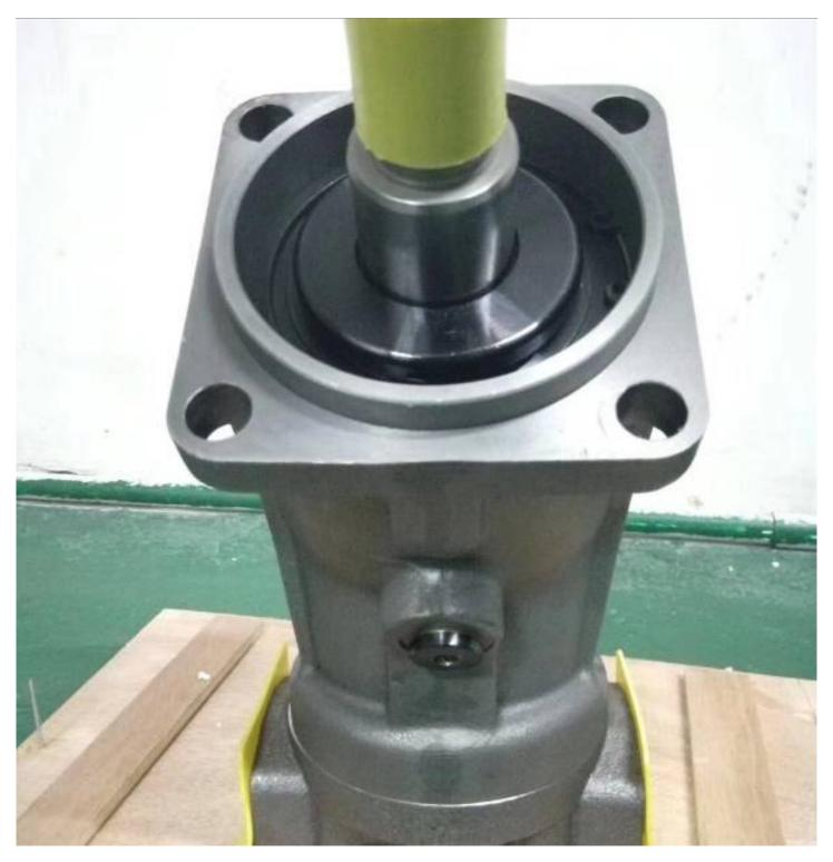
为了保证煤矿机械液压马达的正常运行和延长其寿命,定期维护保养是非常重要的。首先,要确保 液压系统的油质良好,定期更换液压油,并及时清洗液压油箱。其次,要定期检查液压管路和连接件 的密封性,避免泄漏现象的发生。此外,还需注意及时更换液压马达的密封圈和轴承,以防止其磨损 和老化。
