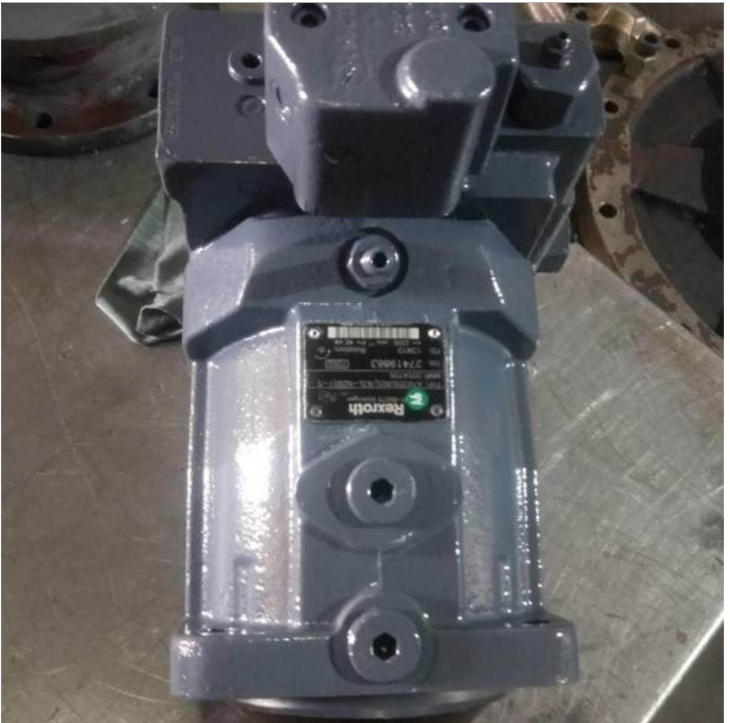
矿用液压泵是专门为矿山行业设计的一种液压设备。矿山作业环境复杂恶劣，操作条件苛刻，常规的液压设备无法满足要求。矿用液压泵以其高压、大流量、耐磨性强等特点，能够适应恶劣的矿山作业环境，保证设备的可靠运行。它广泛应用于井下工作面的动力配套、矿井揭盖、石灰岩爆破等场合，为矿山行业的发展发挥着积极的推动作用。
