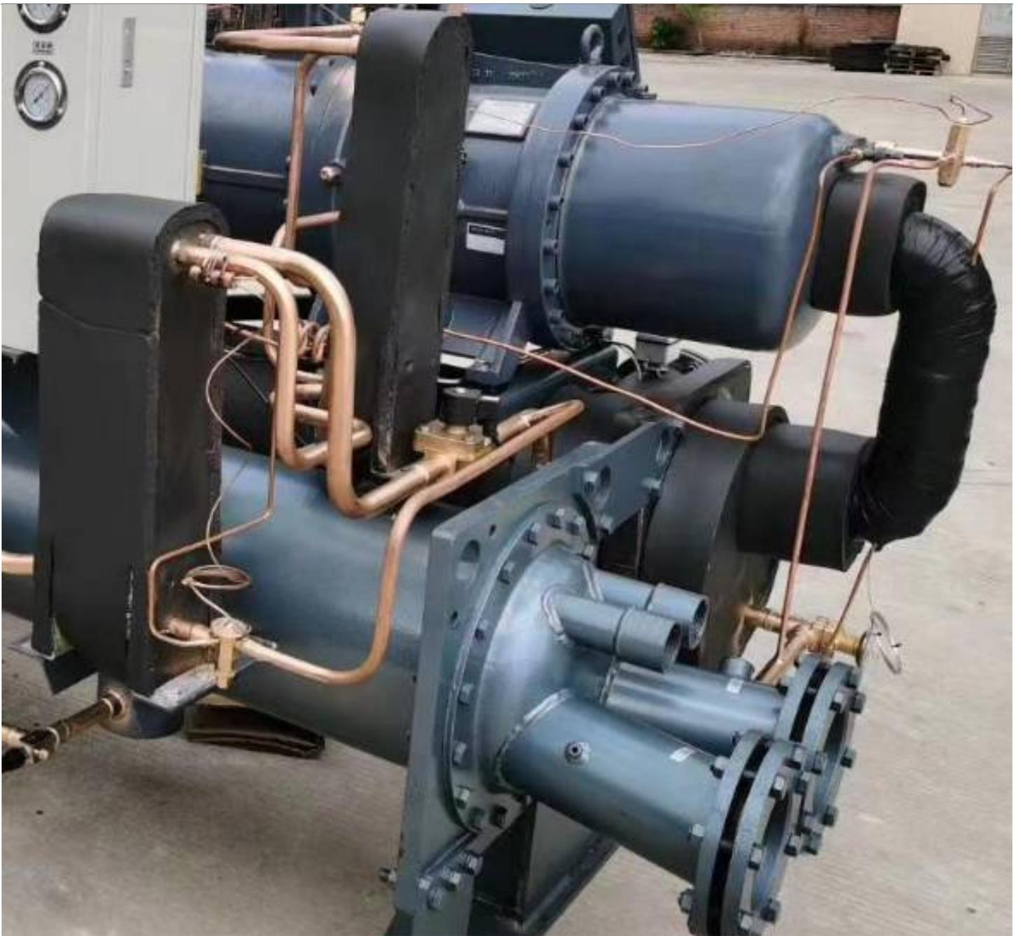
首先，让我们来了解一下螺杆式冷冻机的特点。螺杆式冷冻机采用螺杆压缩机作为压缩元件，具有结构简单、运行稳定、噪音低、效率高等优点。其常用于大型商业中央空调系统和工业冷却设备中，能够提供稳定的冷冻水源，满足各类生产和制冷需求。
