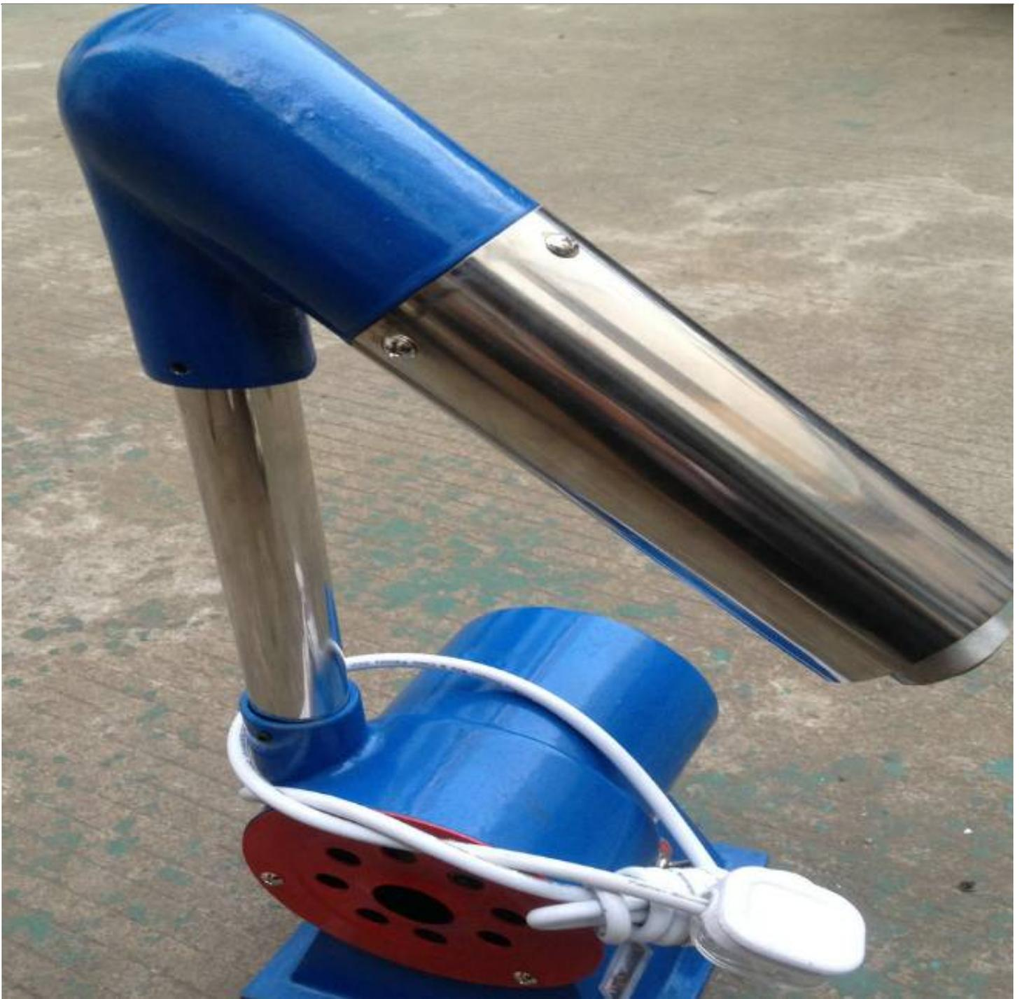
接下来，让我们来了解一下皮革鞋厂烧线机-除皱烘线机。这是一种专为皮革制品而设计的机器，主要用于在制鞋过程中烧线和除皱。如今，越来越多的皮革制品制造商开始采用这种先进设备，以提高产品的质量和生产效率。烧线机的工作原理是利用高温热射流使线头瞬间燃烧，达到烧线效果。除皱烘线机则通过加热和烘干的方式，将皮革上的皱褶和线头处理成平整美观的效果。这些机器具有精确的温度控制、稳定的工作性能和高效的操作，成为现代皮革鞋厂不可或缺的设备。
