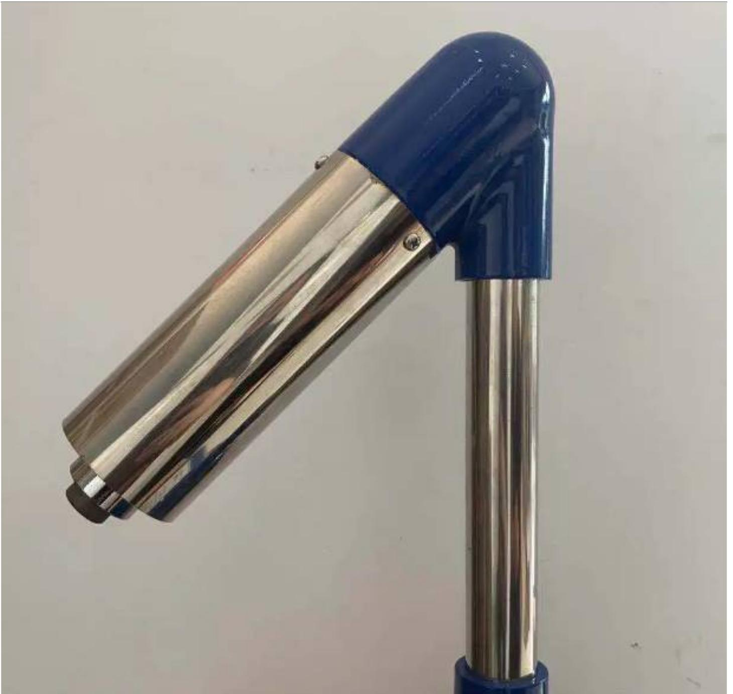
除皱烘线机则是另一种非常重要的吹线制鞋设备。它通过产生热风并将其喷射到鞋类产品上，从而使鞋面上的皱褶得以除去，使鞋类产品更加平整和美观。除皱烘线机不仅可以去除鞋面上的皱褶，还可以提高鞋类产品的鞋型稳定性，使鞋子穿起来更加舒适。
