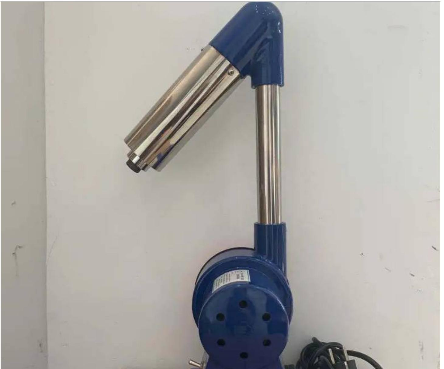
而烘线机作为吹线制鞋设备中的核心部件，它主要负责将吹线后的鞋子进行烘干，使线条更加牢固。烘线机的选择对于制鞋企业来说至关重要。一款好的烘线机不仅可以提高生产效率，还可以保证产品质量，提高产品的竞争力。
