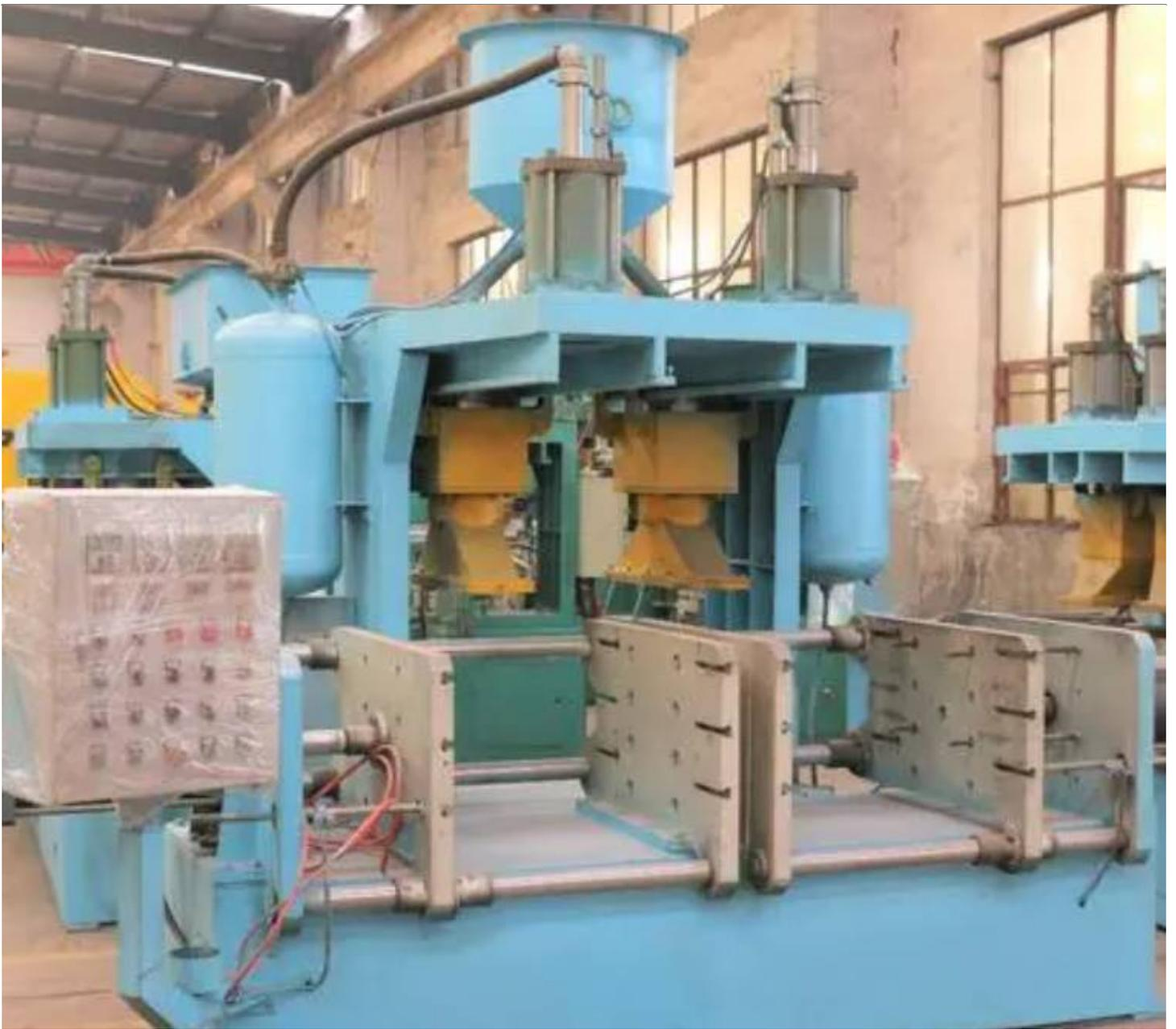
重力倾斜浇铸机还具备能耗低的优点。其采用重力浇注方式，无需额外的能源消耗，只需借助重力即可完成铸造过程。相比其他浇铸方式，重力倾斜浇铸机在能源消耗方面更加节约，减少了工厂的能耗成本。此外，重力倾斜浇铸机的控制系统还具备能源回收功能，可以将热能等再利用，进一步降低能耗。
