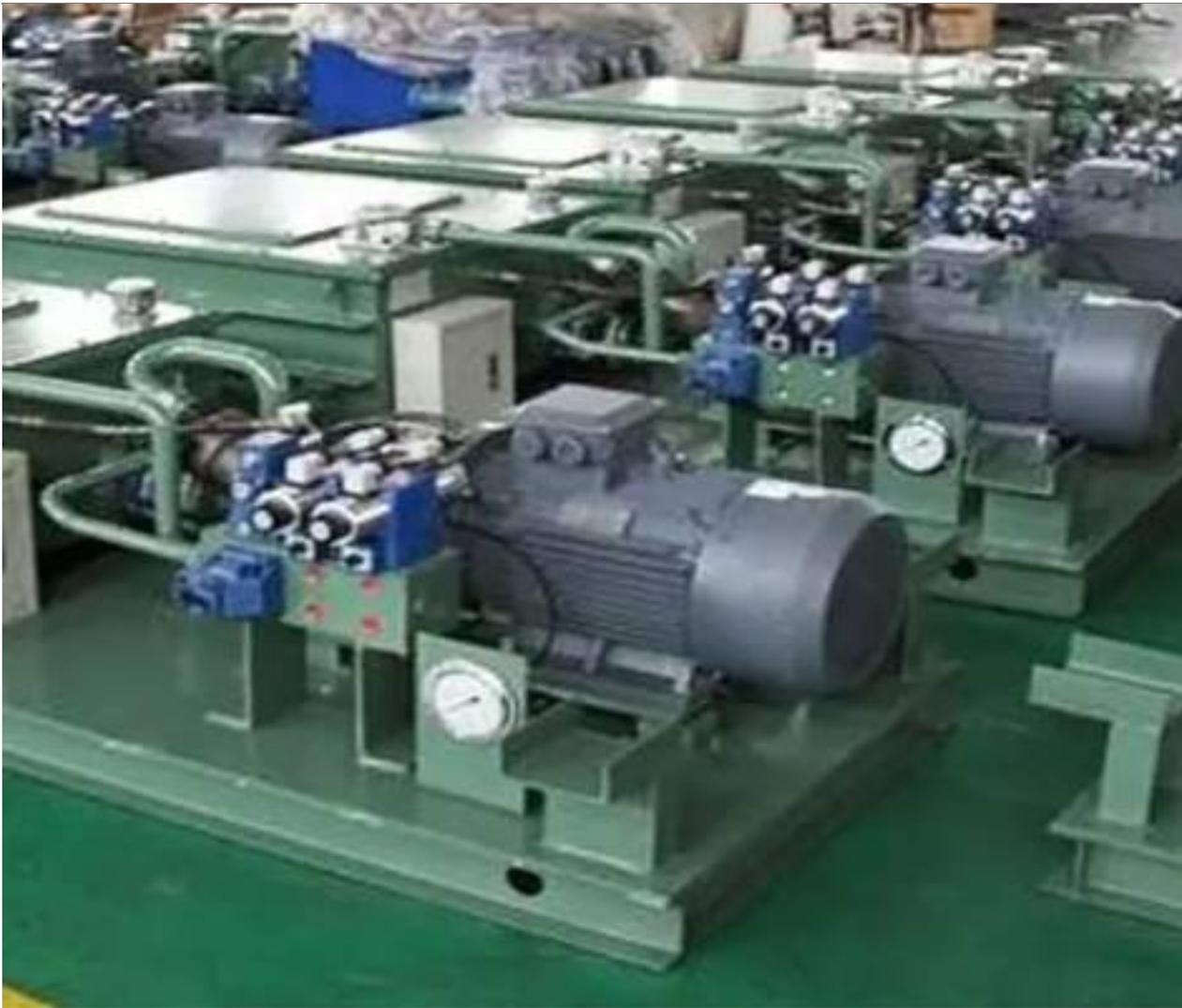
在多点位液压系统中，液压控制单元是关键的重要组成部分。厂家可定制的液压控制单元可以根据搅拌机的具体运行需求进行设计和安装。例如，对于大型搅拌机，液压控制单元可以包含多个油泵和油箱，以满足大流量和高压力的需求。同时，多点位液压系统还可以通过模块化设计，方便后期扩展和维护。
