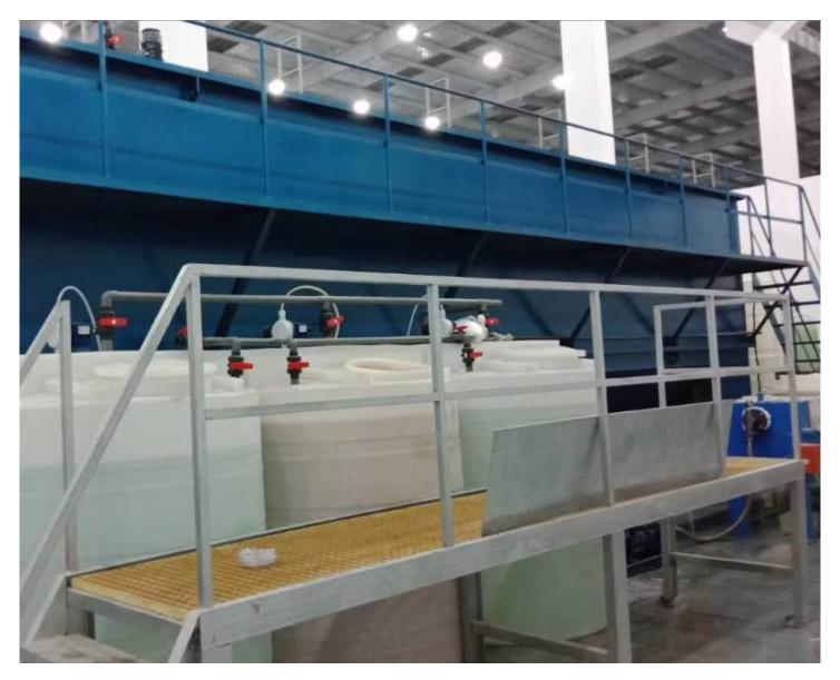
其次,重金属渗滤液处理设备也是非常重要的。石油化工生产中存在的重金属渗滤液是指在生产过程中产生的含有各种重金属元素的液体废物。针对这一问题,重金属渗滤液处理设备采用物理化学联合法进行处理。该设备主要包括初级处理、中级处理和深度处理三个环节。初级处理主要通过沉淀、过筛和过滤等方式,去除重金属渣滓和颗粒物质;中级处理则采用化学沉淀、吸附等技术,去除水中悬浮和溶解的重金属离子;深度处理则通过膜分离、离子交换和电化学方法,将残余的重金属离子进一步去除,使处理后的渗滤液完全达到环保排放标准。
