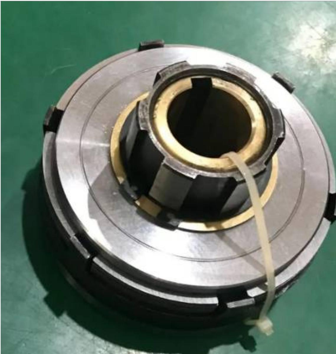
风扇磁粉离合器是一种利用磁粉的磁滞特性实现离合和拖动转矩传递的离合器。它通过改变磁粉的磁感应强度，从而实现离合和拖动转矩的转变。同时，风扇磁粉离合器具有操作简单、可靠稳定、传动效率高等优点，因而被广泛应用于各个领域。
