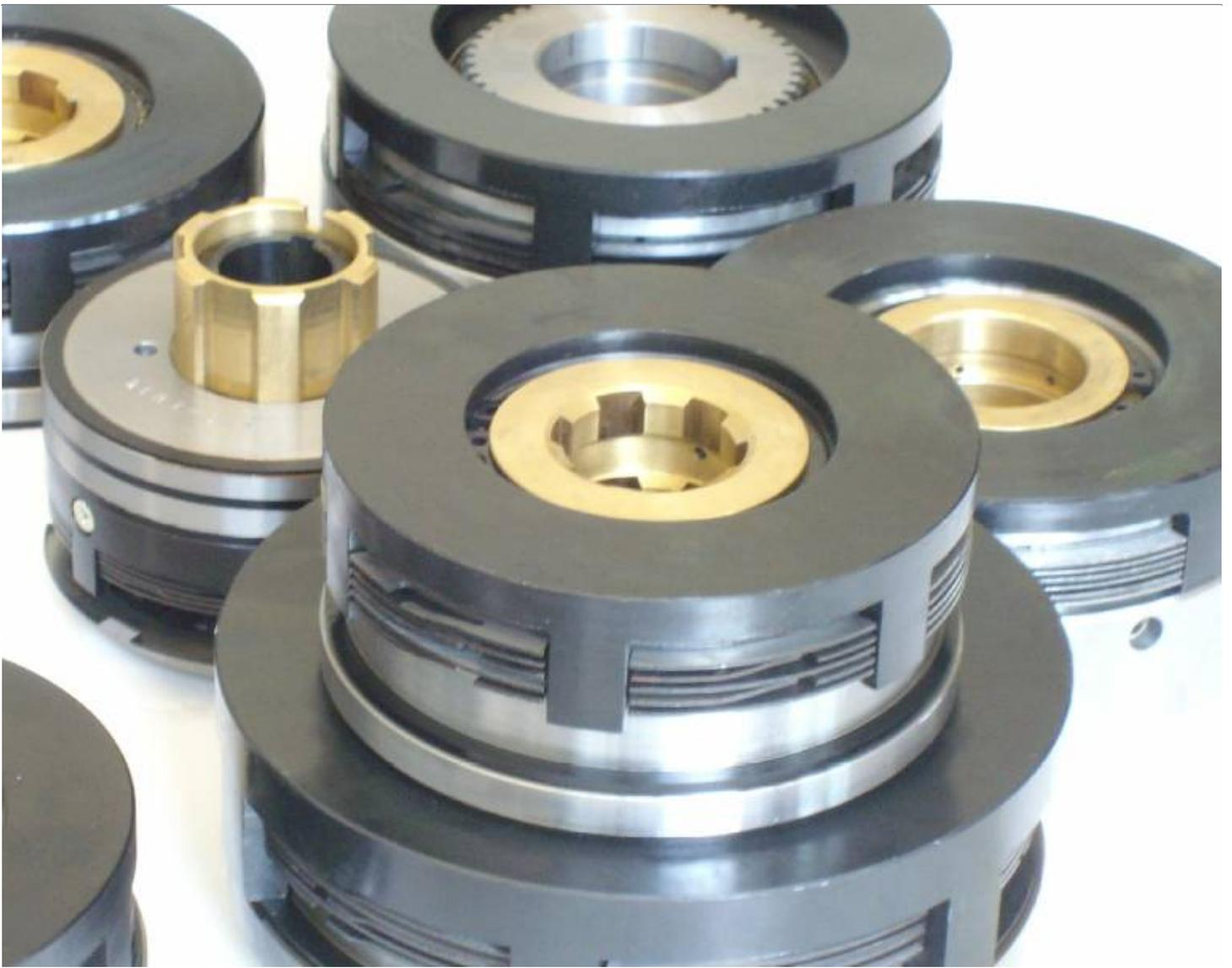
首先，我们先来了解一下双轴磁粉离合器的原理。双轴磁粉离合器采用了磁粉传动的原理，通过控制电磁线圈的通断来实现离合器的联结和脱离。当电磁线圈通电时，磁粉会受到磁化力的作用，使离合器的摩擦盘紧密贴合，实现动力传输；当电磁线圈断电时，磁粉会失去磁化力，使离合器的摩擦盘分离，停止动力传输。这种离合器结构简单，工作可靠，响应速度快。同时，由于双轴磁粉离合器采用了磁流变流体，具有非常好的承载能力和耐磨性，可以满足高转速和大扭矩的工况要求。
