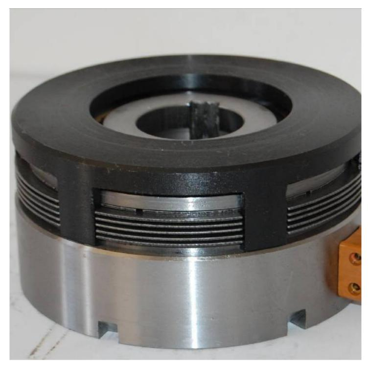
首先,让我们来了解一下电磁离合器的结构和工作原理。电磁离合器由主动盘、从动盘、继电器和电磁线圈等组成。当通过电流激励电磁线圈时,产生的磁场会使主动盘上的离合片贴合从动盘,从而实现传递扭矩。当电流停止传输时,离合片便会分离,从而分离传动装置,起到传递和分离的作用。
