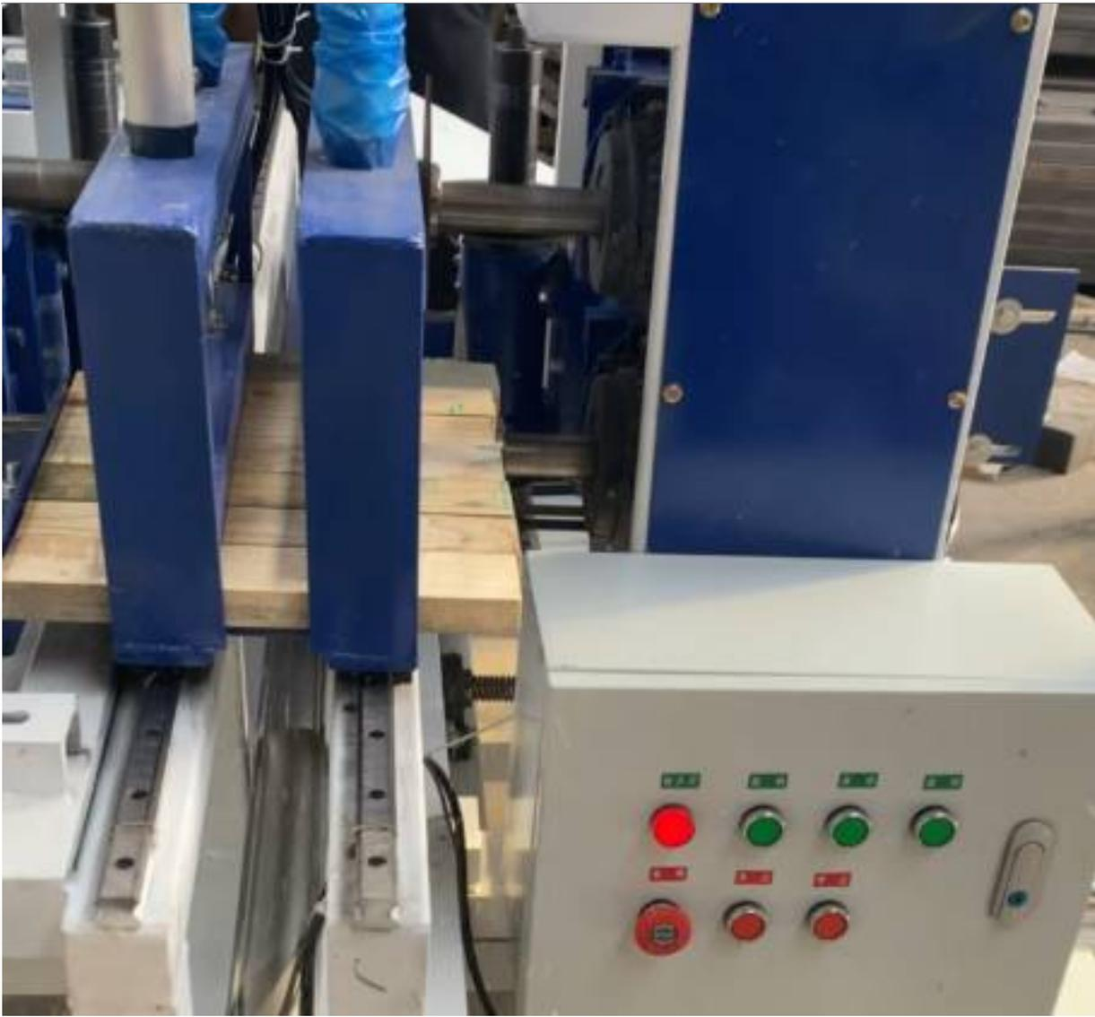
与圆木多片锯相比，圆盘锯主要用于对木板进行精细切割。它采用一块圆形状的锯片，通过高速旋转进行切割。圆盘锯具有切割精度高、速度快的特点，适用于对木板进行细致加工。圆盘锯可以通过调整切割角度和锯片的深度，实现不同形状和尺寸的切割，满足不同需求。
