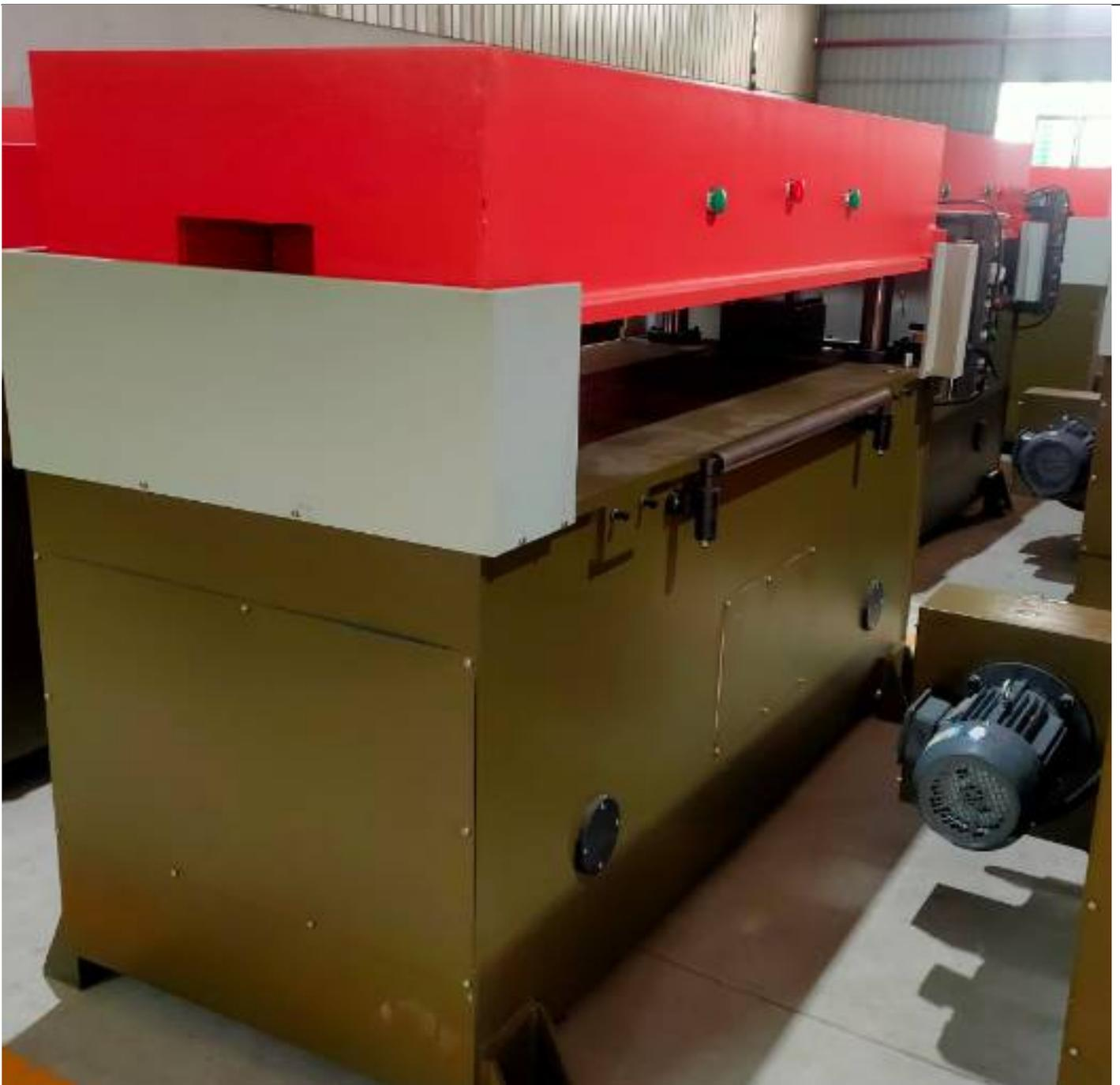
在裁剪过程中，供应平板裁断机表现出色。首先，它采用液压系统驱动，具有较高的裁切力度和稳定性。这意味着它能够轻松应对各种材料，包括厚度较大的材料。此外，它还具有优异的切割精度和质量，保证了裁剪后的材料边缘平整，无毛刺，减少了后续处理的工作量。
