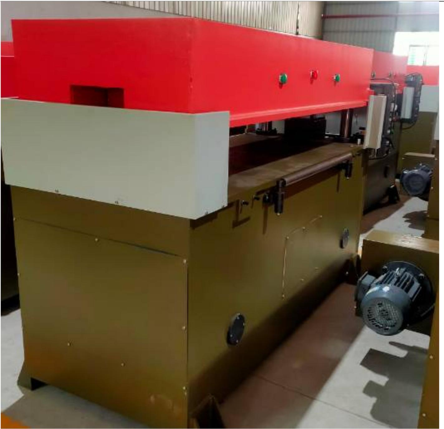
PVC裁切生产线采用先进的切割技术和控制系统，能够自动完成材料的定位、切割和排出等工作。它通常由送料系统、切割系统、排料系统和控制系统四部分组成。
