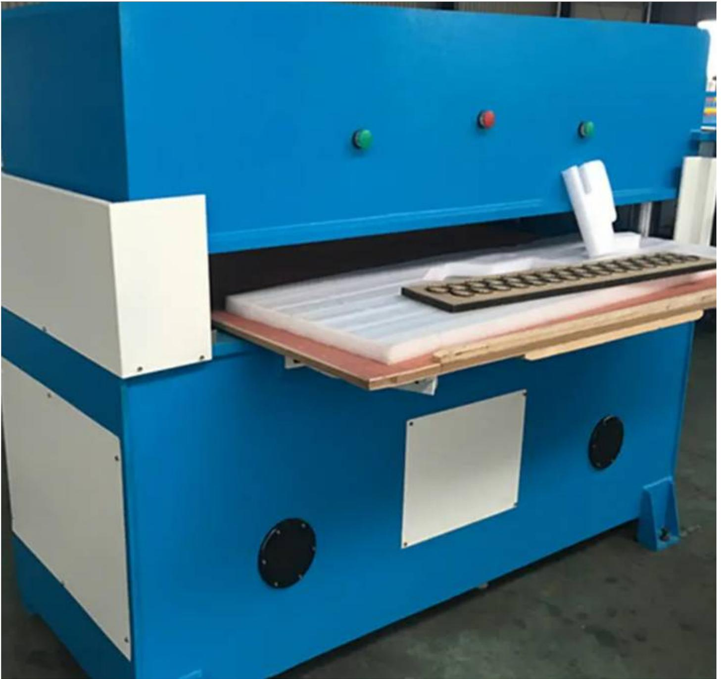
其次，在使用液压裁切机时需要掌握一些注意事项，以确保其稳固运行。首先，要注意设备的定期维护保养，包括清洁设备表面和内部杂物、添加润滑油等。此外，还应定期检查设备的各个关键部位，如刀具、电气元件等，以确保其正常运行。另外，设备在使用过程中要注意操作规范，确保裁切过程平稳进行，避免因操作不当导致设备晃动、产生噪音等问题。
