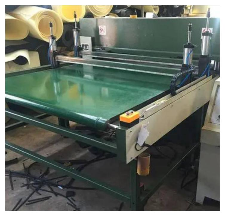
相比传统的手工裁切方式,振动刀裁剪机具有明显的优势。首先,它可以以极快的速度完成裁剪任务,大大提高了工作效率。其次,自动送料功能使得操作更加便捷,只需将材料放置在工作台上,机器就能够自动将材料送入裁切区域,减少了人力和时间的浪费。此外,振动刀裁剪机还具备精确控制的能力,可根据不同的需求进行调整,以满足个性化的裁剪要求。
