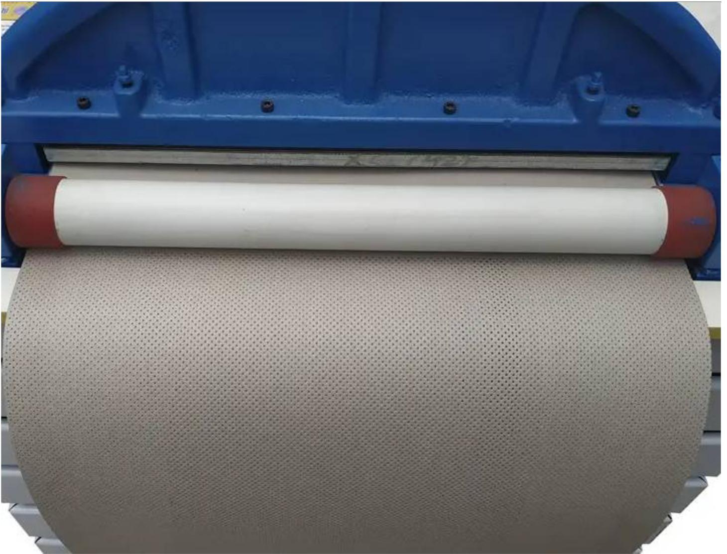
与此同时，皮革激光冲孔机也在各个行业中发挥着重要作用。传统的皮革冲孔工艺常常需要使用复杂的模具，造成成本高昂且制作周期较长。而皮革激光冲孔机却能够通过激光束的高能量作用，直接将孔洞在皮革上冲出，实现高效、高精度的冲孔加工。不仅如此，皮革激光冲孔机还能够实现各种图案的雕刻，为皮革制品增添了独特的文化内涵和艺术价值。
