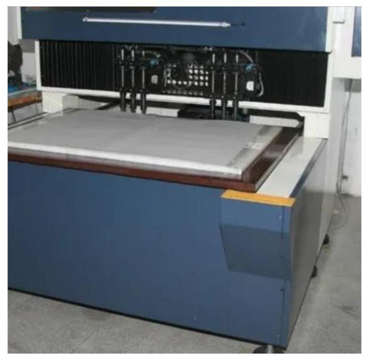
皮革激光冲孔机利用激光束对皮革进行加工,通过控制激光束的强度、频率和方向等参数,实现对 皮革材料的精确冲孔。它的工作原理类似于传统的激光切割机,但是在冲孔过程中,激光束所施加的 力度和速度要更加精细和准确,以确保每个孔洞的大小和位置都能够达到客户的要求。
