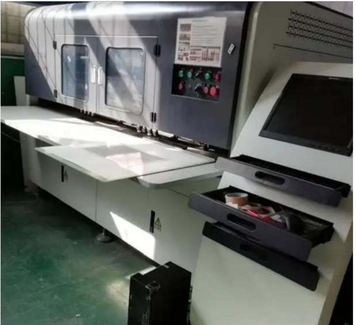
这款双工位皮革激光切割机具备先进的激光切割技术，能够精确地切割各种厚度的皮革材料。它配备了优质的光学系统和高速运动系统，确保切割过程更加稳定和高效。不仅如此，这款机器还具备智能化控制功能，通过预先设定的程序可以轻松实现不同款式的冲孔和雕花效果。
