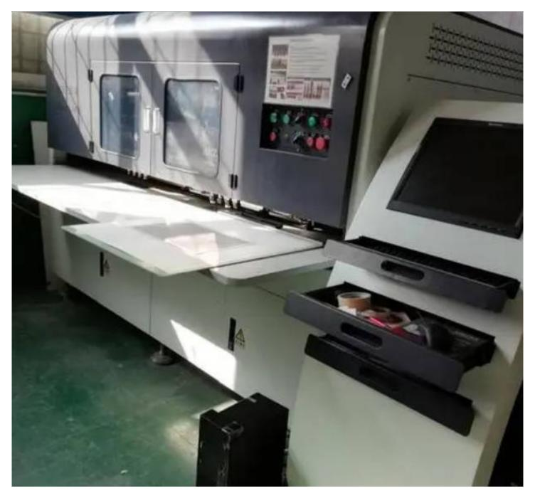
高精度皮革冲孔机采用先进的数控技术和精密的模具,可根据用户的要求定制各种尺寸和形状的冲孔孔型。其高速旋转的冲孔刀具能够精确锁定冲孔位置,并在短时间内完成冲孔操作,确保每个孔的位置和尺寸精准无误。这对于一些需要进行多孔冲孔的产品,如皮带、鞋子和皮包等,尤为重要。高精度冲孔不仅提高了产品的质量和美观度,还能为后续的缝合、装饰等工序提供更好的加工基础。
