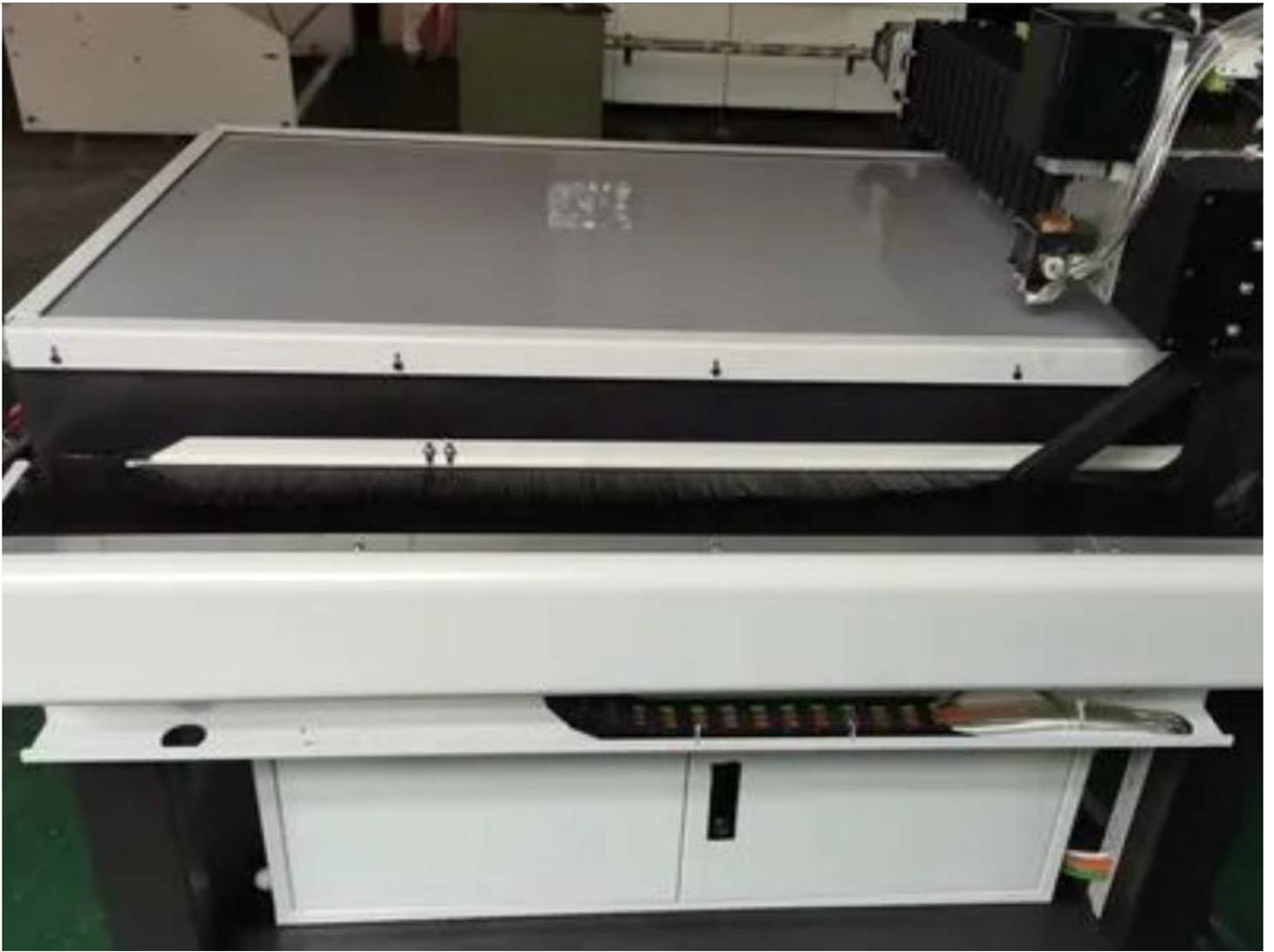
首先，皮鞋激光冲孔机具有极高的自动化程度。只需要将设计好的图案输入到机器中，设定好冲孔参数，机器便可以自动进行冲孔操作。这不仅减少了人力成本，提高了生产效率，而且还可以确保每一双鞋子的冲孔图案都完美无瑕。
