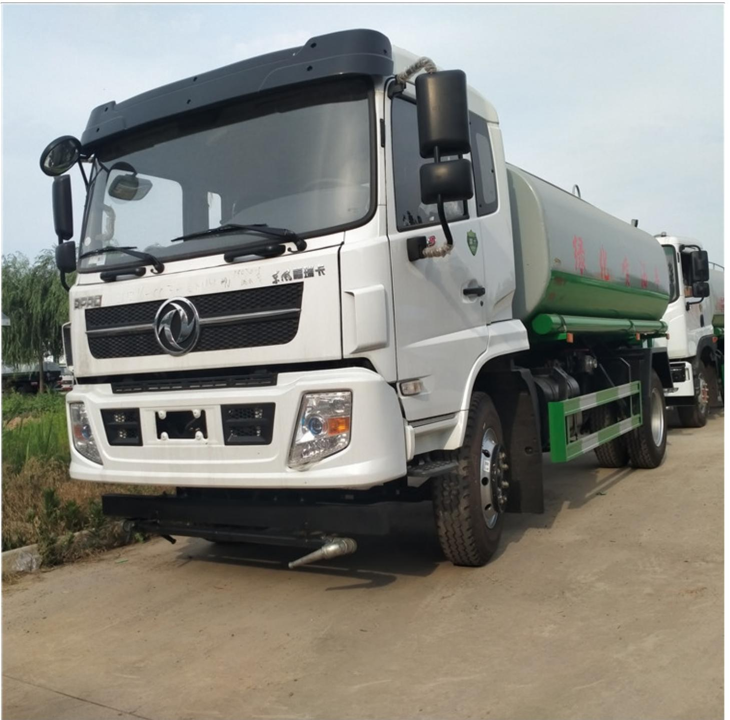
洒水车是指采用东风公司生产的二类底盘，加装水罐和水泵等制作而成的洒水车。主要用于各种路面冲洗，树木、绿化带、草坪绿化，道路、厂矿企业施工建设，高空建筑冲洗。具有洒水、压尘、高、低位喷洒，农药喷洒、护栏冲洗等功能。 改装配置：罐体采用4MM厚武钢专用容积板制作，洒水车前冲（喷）后洒，带侧喷，罐体后带工作平台，平台上安装绿化洒水炮，洒水炮可全方位旋转，可连续调成直冲状、大雨、小雨、毛毛雨，带安全护栏，配备大功率专用洒水泵，泵可自吸自排，安装过滤网，带消防接口，可通过消防栓进水，带自流阀，随车选装20米绿化卷盘，可喷洒农药。罐体材料多采用优质碳钢板生产。特殊用途的情况下也可以根据客户的需要采用304不锈钢。罐体容积为“4立方、5立方、6立方、8立方、10立方、13立方、15立方”20立方等。公司热线电话：150540525
