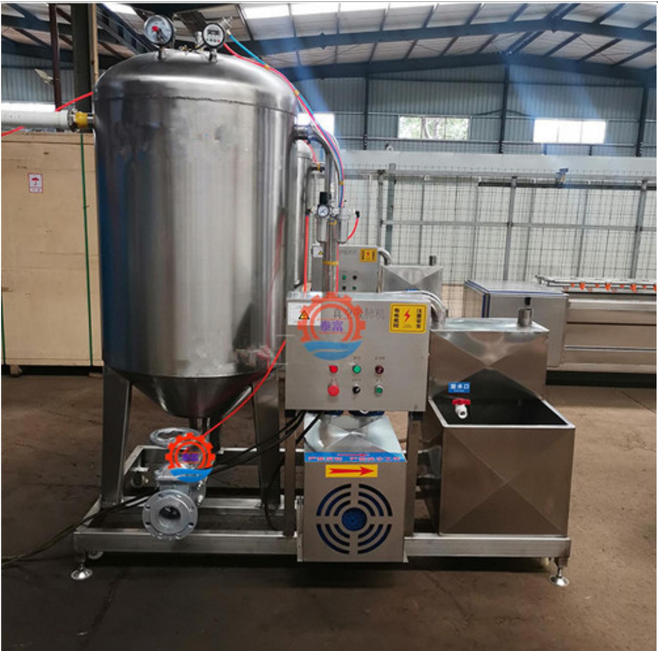
鸡自动吸肺机是用于清理鸡肺而使用的一款自动化设备。工作效率比较高、而且操作简单、工作原理1、真空罐形成负压真空，使用压力-0.06—-0.07Mpa，极限压力-0.08Mpa。2、流水线上的鸡，被宰鸡掏肺机吸肺枪把肺等内脏吸走，吸走的内脏进入真空罐底部。吸肺枪的接通阀一端与真空罐相接，另一端通过软管与枪头相接，气动控制气阀的准确开启与关闭。3.排出内脏，建议用户每天把宰鸡掏肺机吸肺机的真空罐清空一下，下班前用吸肺枪吸水清洗吸肺枪和管道，打开联通阀，打开排污阀，排出真空罐内的脏物。
