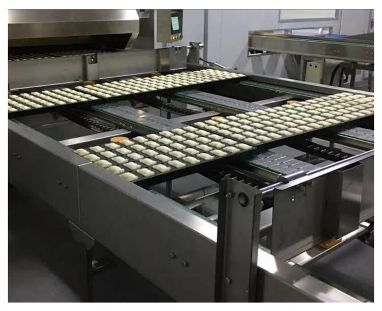
饼干包装机使用的材料一般是食品级塑料,具有良好的耐用性和卫生性。在挤出机的工作过程中, 饼干经过输送带由传送带系统运送到下一工位,然后通过模具或夹具对饼干进行定位,使其能够精确放置在包装袋中。随后,挤出机会进行封口和裁剪,确保饼干包装的完整性和美观性。
