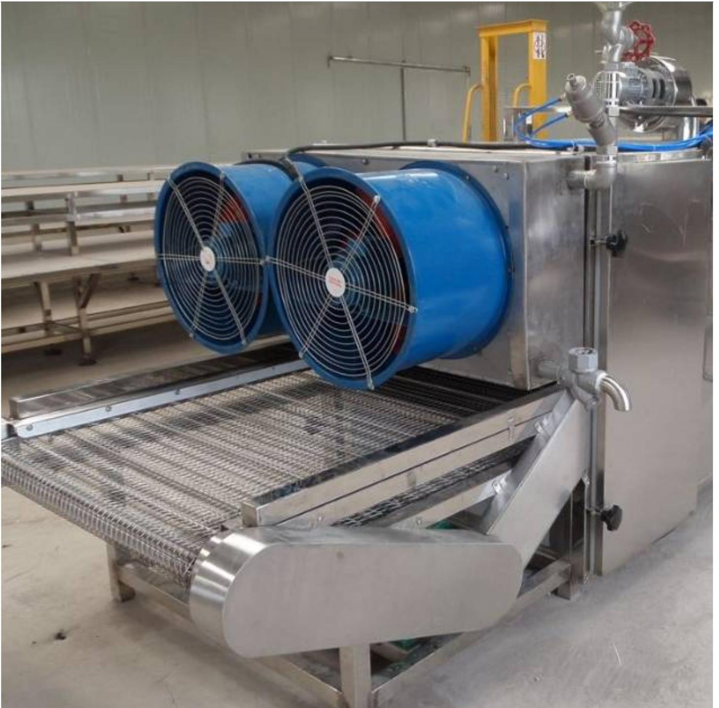
辣椒干燥机的材质选择对设备的性能和耐用性起着至关重要的作用。一般来说，辣椒干燥机的主要材质有不锈钢和碳钢两种。
