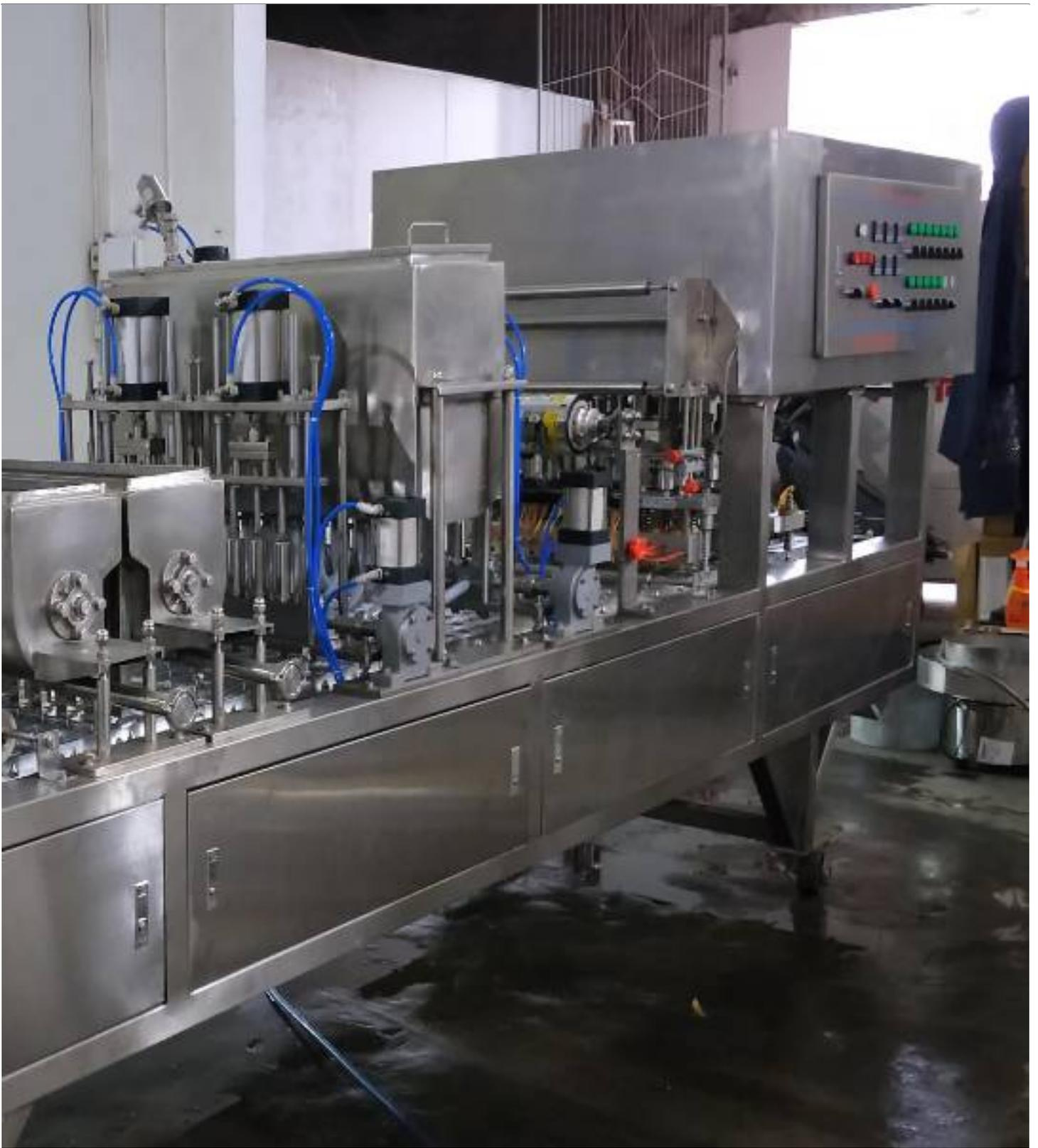
酱菜巴氏杀菌线是制作罐头酱菜的关键设备之一。它采用先进的杀菌技术，能够高效地杀灭食品中的微生物，延长食品的保质期。同时，该设备还能够保持食品的原始风味和营养成分，确保食品的口感和品质。酱菜巴氏杀菌线的主要组成部分包括：预处理系统、灌装系统、杀菌系统、冷却系统、消毒系统等。每个部分都有专门的功能，配合紧密，确保食品加工的顺畅和安全。
