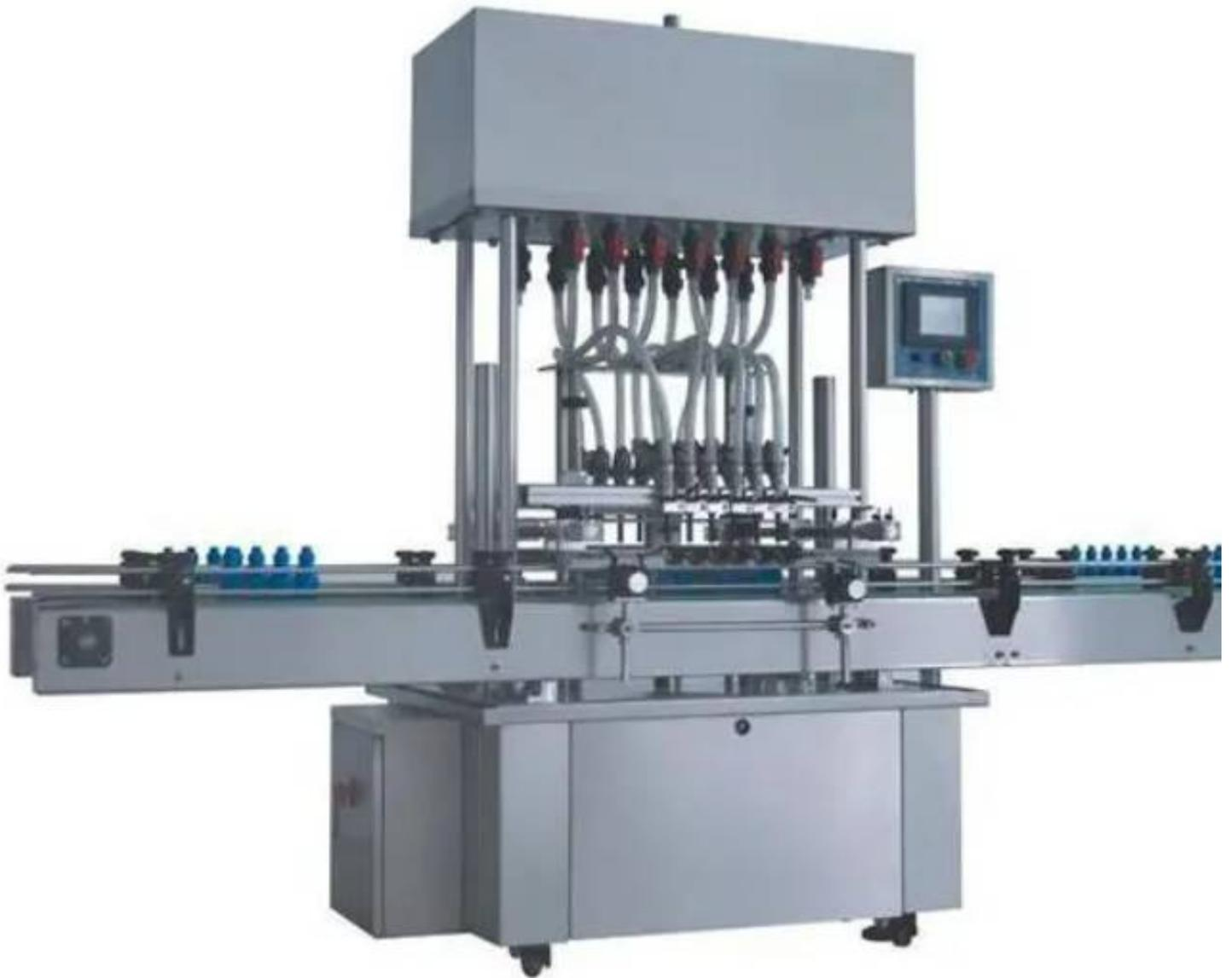
高自动化程度是瓶装灌装机的一大特点。它通过采用先进的传感器、PLC控制系统和人机界面，实现了对灌装过程的自动监控和控制。在灌装过程中，瓶装灌装机可以实时检测瓶子的位置、液位和压力，并根据设定的参数进行精确的控制。同时，它还自动调整灌装速度和液位高度，以适应不同规格和容量的瓶子，确保每个灌装都能达到预期的效果。
