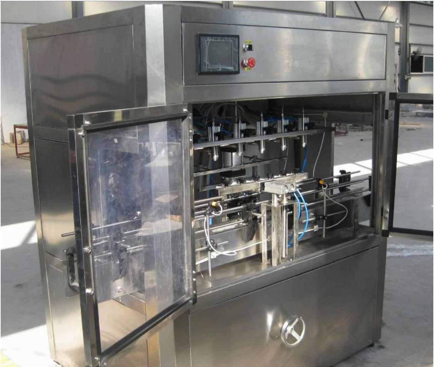
智能灌装设备采用先进的传感技术和控制系统，能够精确测量和控制灌装液体的流量和容量。它通过流量计和电子控制阀门，根据设定的参数实现自动定量灌装，保证每个包装的准确性和一致性。同时，智能灌装设备还配备了高精度的称重系统，能够在灌装过程中实时监测和调整液体的重量，确保每个产品都符合标准要求。
