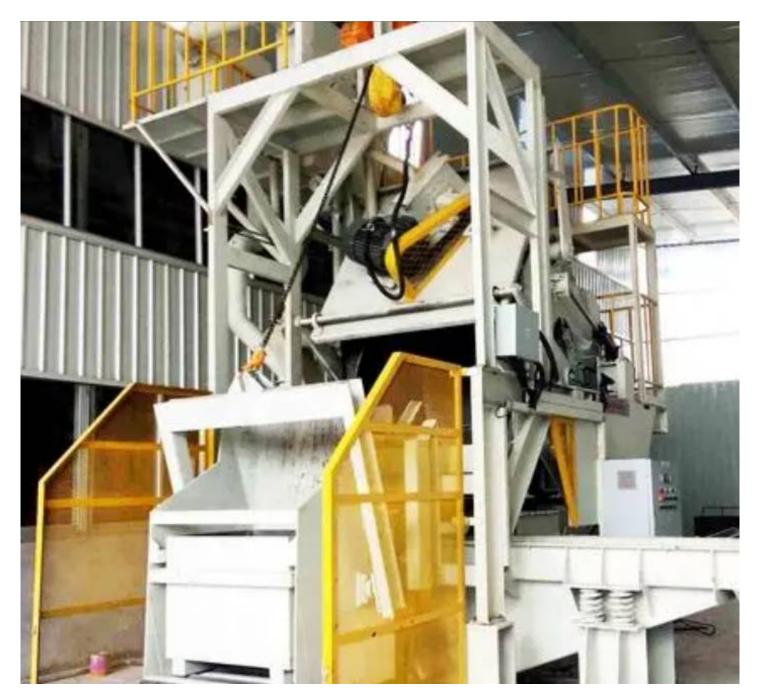
滚筒式抛丸清理机的工作原理是利用抛丸物料在高速旋转的滚筒内产生的冲击力和磨擦力,对工件表面进行清理。抛丸物料可为不同的材质,如钢丸、铝丸、铁丸等。在滚筒旋转的同时,工件被放置在滚筒内,抛丸物料通过喷射装置进入滚筒,从而与工件表面发生碰撞和磨擦,彻底除去表面的氧化物、油污、锈蚀等。
