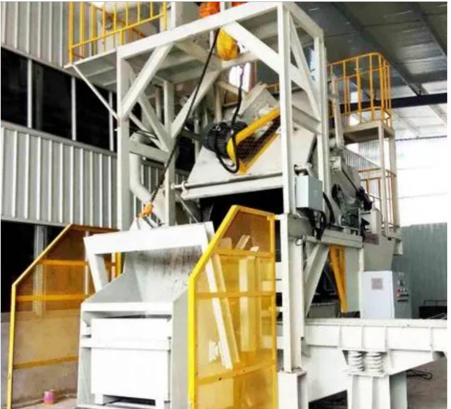
首先，滚筒式抛丸清理机可以实现高效清理。由于滚筒的高速旋转以及抛丸颗粒的高速冲击，它能够迅速而彻底地清除铸件表面的污染物，大大提高清理效率。这对于一些需要高精度和高质量的铸件尤为重要，可以节约时间和人力成本。
