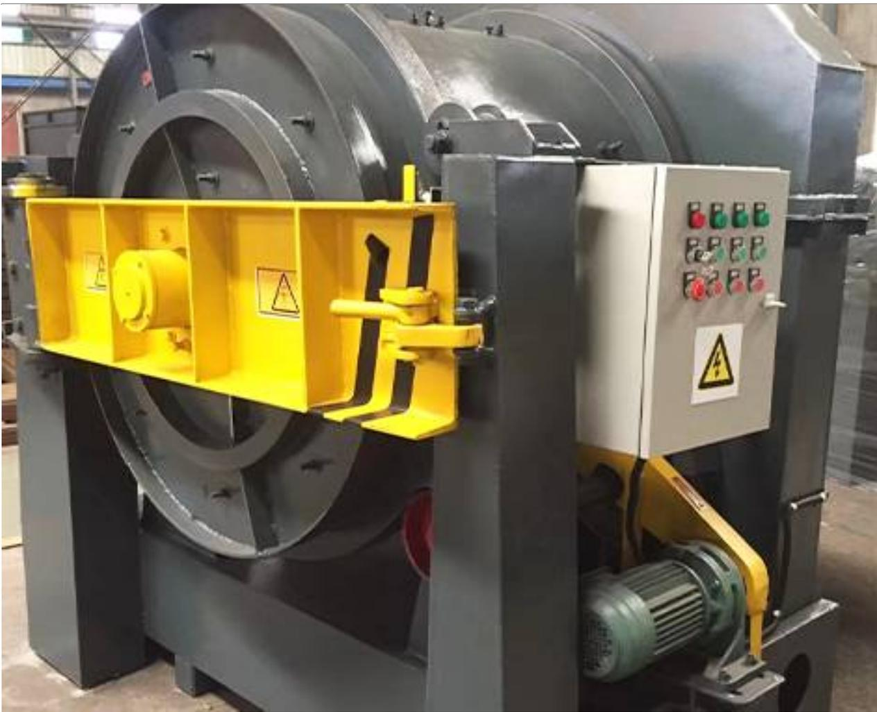
滚筒式除锈机的应用领域十分广泛。在钢铁、汽车、船舶、桥梁、建筑等行业中，常常需要进行除锈处理。传统的除锈方法往往耗时耗力，并且效果不理想。而滚筒式除锈机的出现，彻底改变了这一现状。不论是大型工件还是小型零件，都可以轻松应对，高效完成除锈工作。同时，滚筒式除锈机还可以通过调整滚筒的旋转速度和抛丸物料的种类，来适应不同工件材质和除锈要求，具有很大的灵活性。
