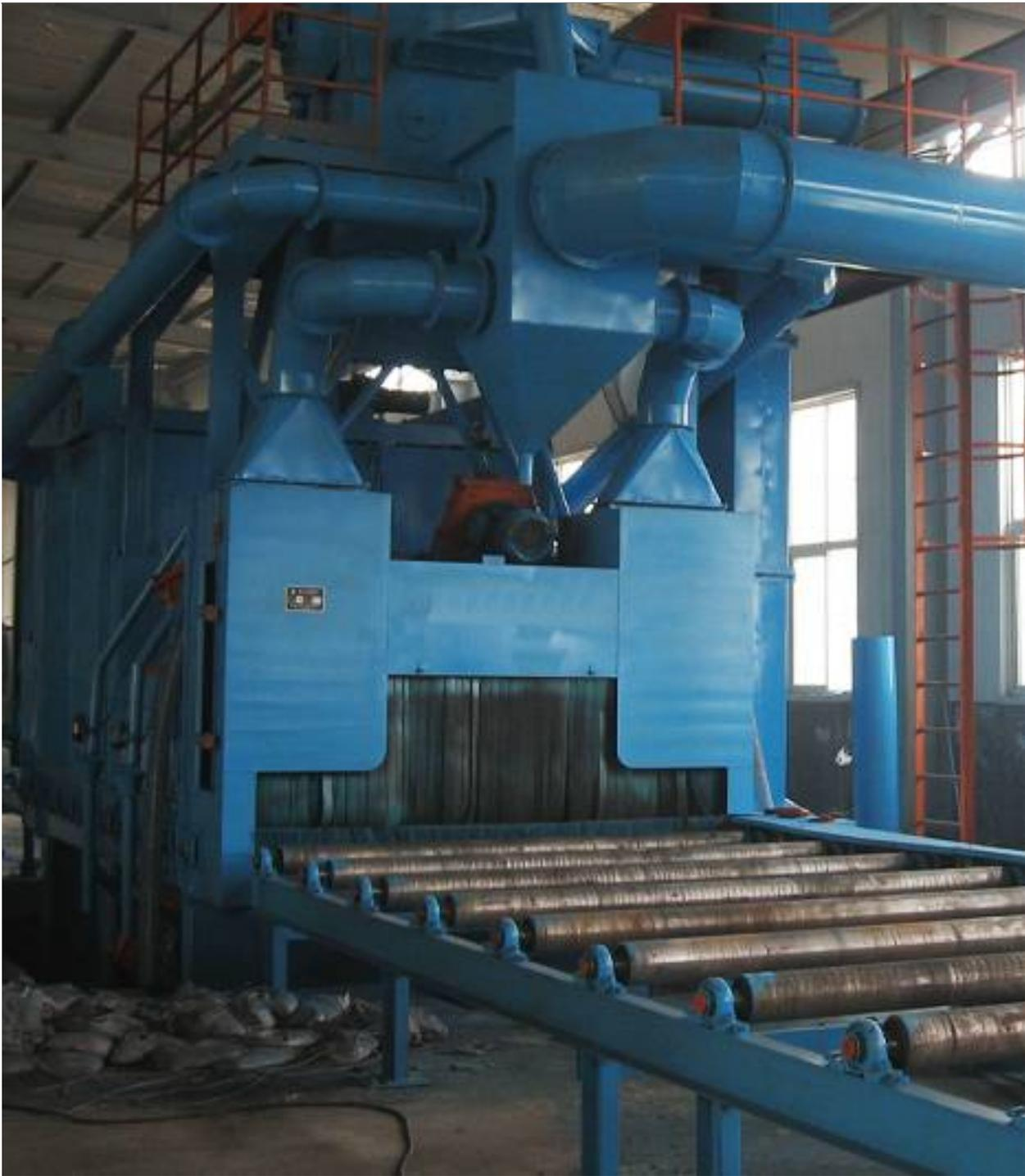
在工业生产中，滚筒式抛丸机的用途十分广泛。它可以用于对各种各样的工件进行表面处理，例如铸铁件、钢铁件、铝合金件、铜件等。不仅如此，它还适用于各种行业，包括汽车制造、航空航天、铁路交通、机械制造等。相比于其他清洁方法，滚筒式抛丸机具有更好的清理效果和更广泛的适用范围，能够满足不同行业的需求。
