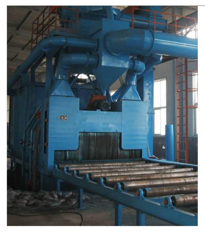
首先,滚筒抛丸机是一种利用高速旋转的滚筒将抛丸物料投射到工件表面的设备。这些抛丸物料可以是不同形状和材料的小颗粒,比如钢丸、铝丸、石英砂等。当滚筒旋转时,抛丸物料会被投射到滚筒内壁,并通过滚筒的旋转和倾斜运动,沿着工件表面进行抛射。
