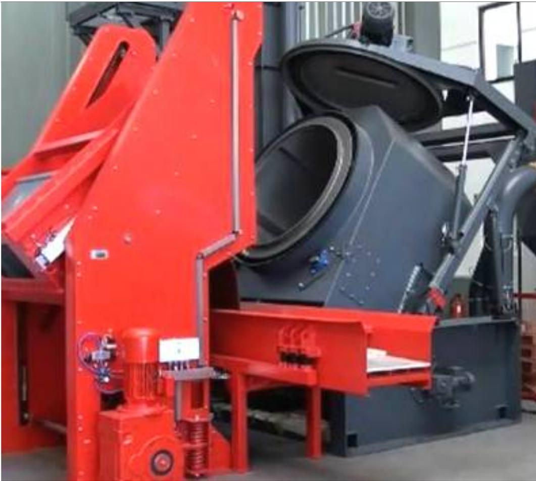
接下来，让我们来了解一下滚桶抛丸机。滚桶抛丸机是一种利用滚筒的高速旋转和抛射物流的冲击力来清理工件表面的设备。滚桶抛丸机通常由一个倾斜的滚筒和一个旋转装置组成，工件被放置在滚筒中，随着滚筒的旋转，抛射物流将工件表面的污垢和氧化物击打掉。滚桶抛丸机适用于各种形状的工件清理，如钢管、钢板、钢筋等，具有处理速度快、清理效果好、操作简单等特点。
