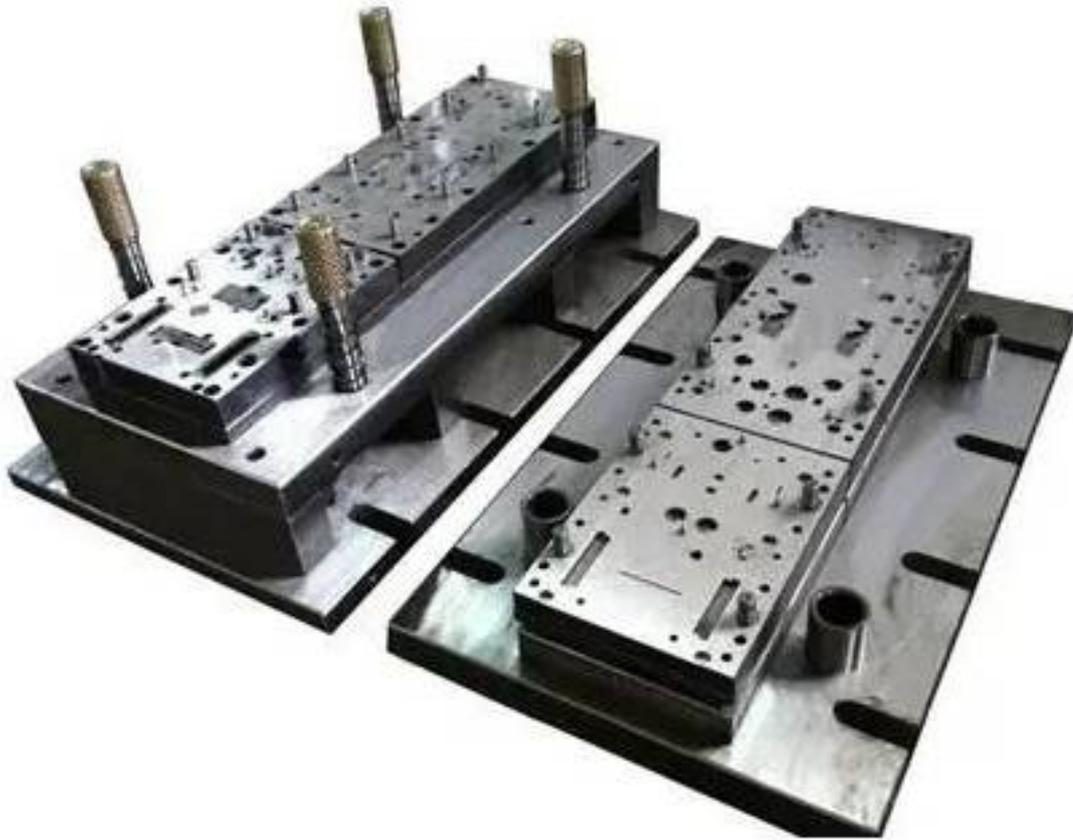
接下来，让我们来探讨冲裁模的选择。冲裁模的选择主要考虑模具材料、尺寸和结构设计。对于冲裁模而言，材料的选择至关重要。常用的冲裁模材料有合金钢和硬质合金等，这些材料具有高强度和耐磨性，适用于金属材料的裁剪和冲孔。尺寸的选择应根据产品的尺寸要求来确定，以确保冲裁模能够精确裁剪金属材料。结构设计方面，冲裁模需要考虑模具的定位方式、刃口设计和排屑方式等。不同的设计可以提高冲裁模的定位精度和切削效率。
