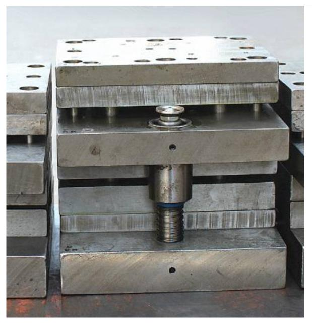
接下来,我们来了解一下拉深模的成型原理和应用场景。拉深模是一种常用于金属板材成型的模具,它主要通过将金属板材拉深入模具中,使其发生塑性变形,从而得到所需形状的工件。拉深模具通常由上模、下模和凸模组成,通过上下模的闭合和凸模的运动,将金属板材拉深成型。拉深模的应用非常广泛,特别是在汽车零部件制造、家电制造和航空航天等领域,都需要使用到拉深模进行工件的成型。
