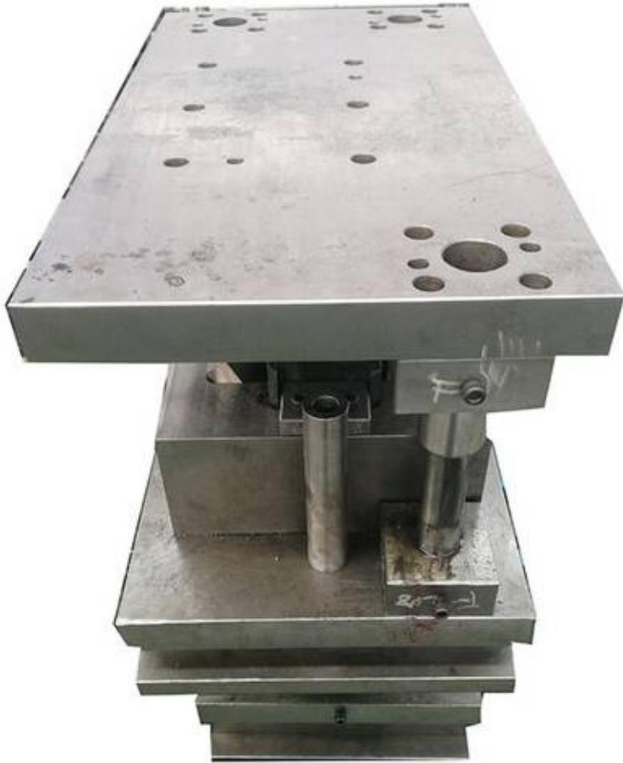
其次，冲压成型模也是连续冲压拉伸模具中的重要组成部分。冲压成型模是控制产品形状和尺寸的关键工具。它们通过控制冲压力度、冲压速度和冲压角度等参数，来达到精确模具的效果。冲压成型模的设计和制造需要细致入微的考虑，以确保产品的精确性和稳定性。同时，冲压成型模的耐磨性和耐腐蚀性也是决定其寿命和使用效果的重要因素。
