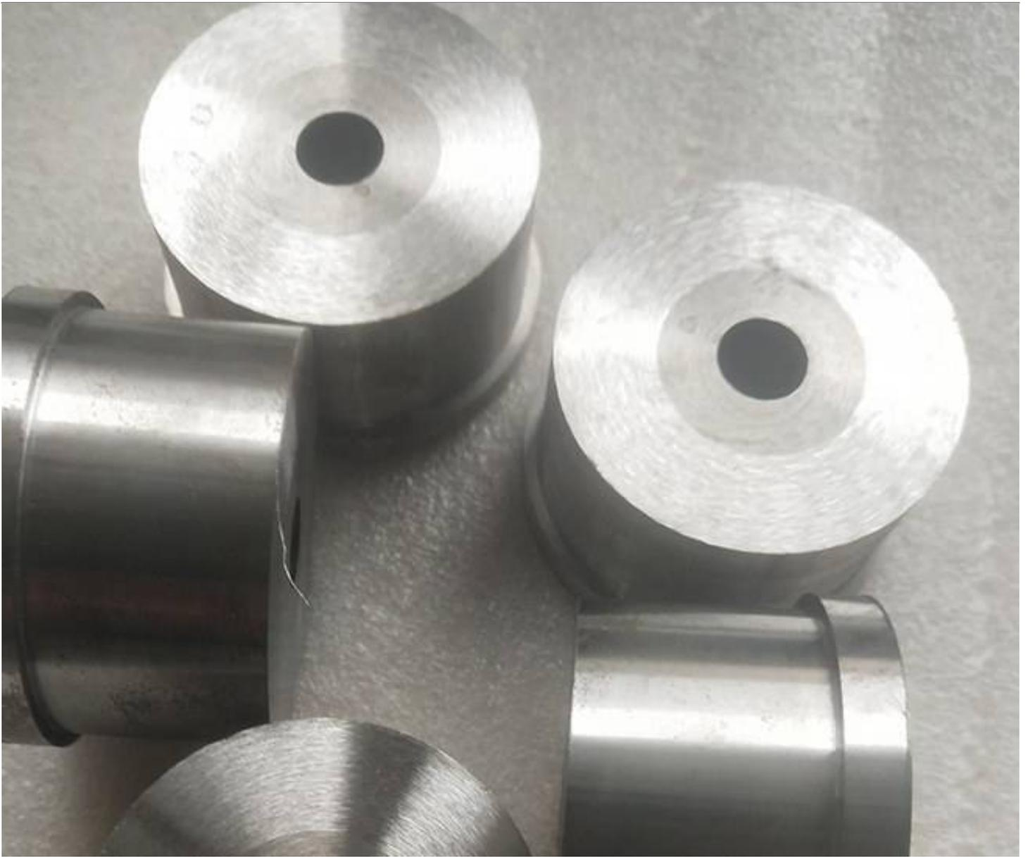
其次，在考虑规格的基础上，还需注意冷墩模具的材质和质量。常见的冷墩模具材质主要有合金钢、高速钢和硬质合金等。合适的材质能够保证模具的耐磨性和耐用性，对于长期生产而言非常重要。此外，模具的表面光洁度和精度也需要重视，可以通过观察样品或参考用户评价来进行判断。
