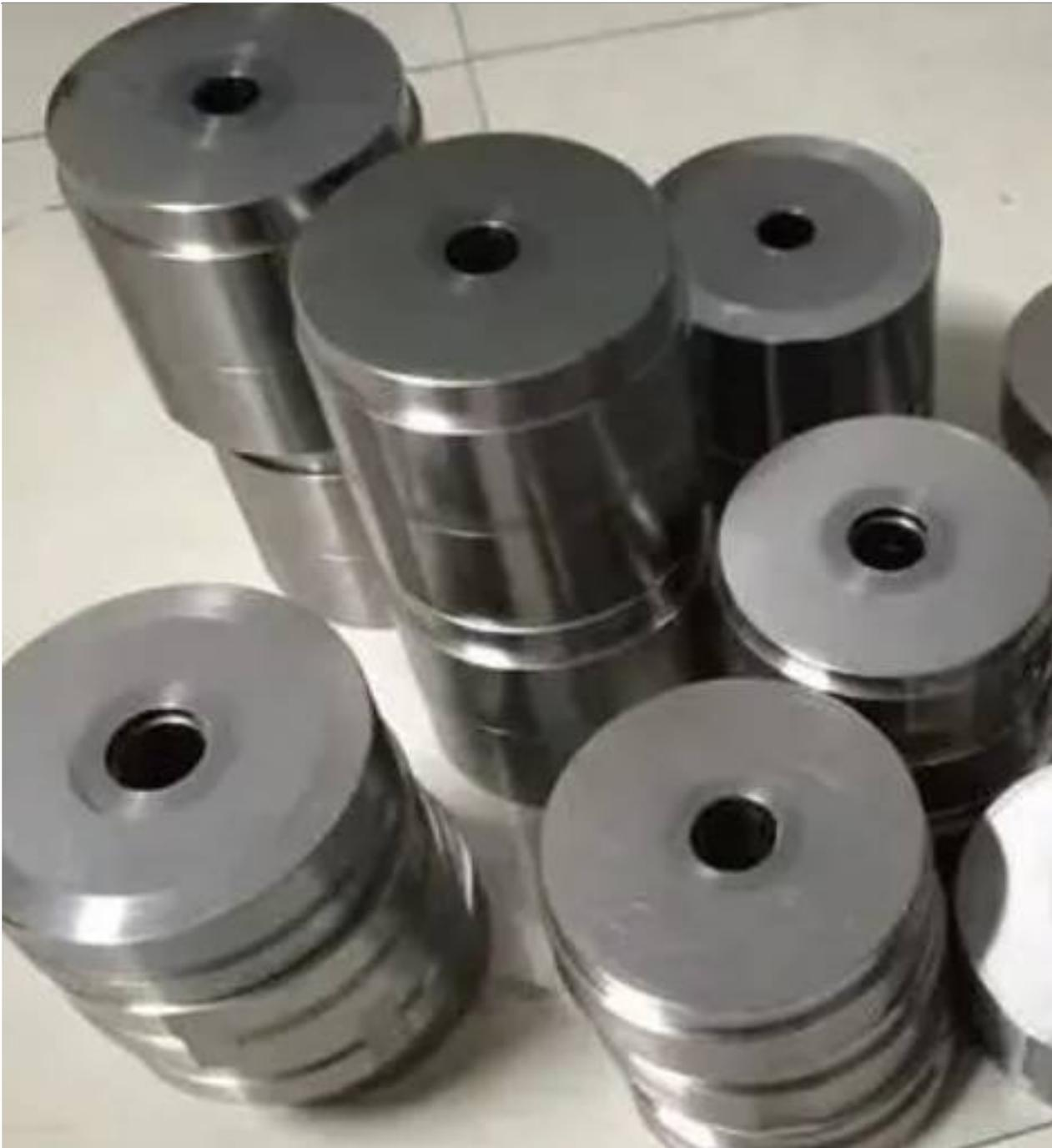
其次，冷拉异形冷镦模具的设计是冷镦加工中的关键环节之一。冷拉异形冷镦模具是用于将圆钢拉伸成异形断面的工具，在冷镦产品的生产过程中起到至关重要的作用。在设计冷拉异形冷镦模具时，需要考虑到钢材的材质、强度和拉伸比例等因素，合理确定模具的形状和尺寸，以确保冷拉过程中钢材的拉伸均匀，不产生变形和裂纹等缺陷。
