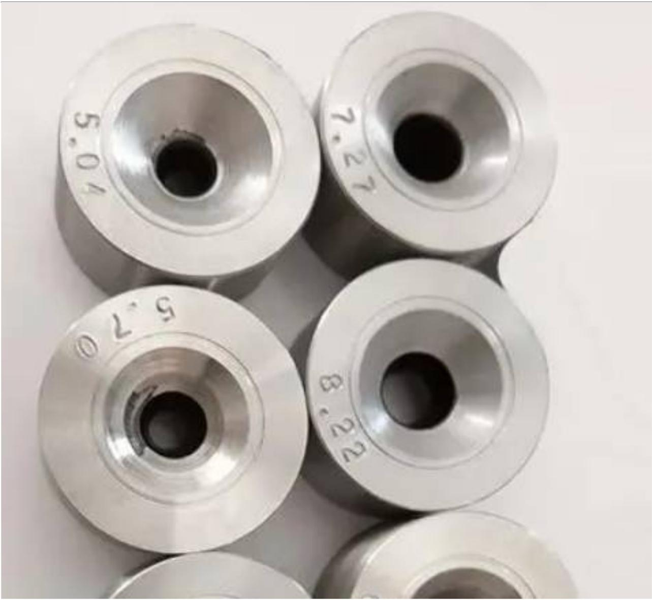
1.圆孔拉丝模：圆孔拉丝模是最常见的一种拉丝模具。它由一个圆孔和一个通道组成，金属材料通过通道进入圆孔，在圆孔的作用下，金属材料被拉伸成丝状。圆孔拉丝模具适用于制作直径较小的金属丝，例如电线、细针等。
