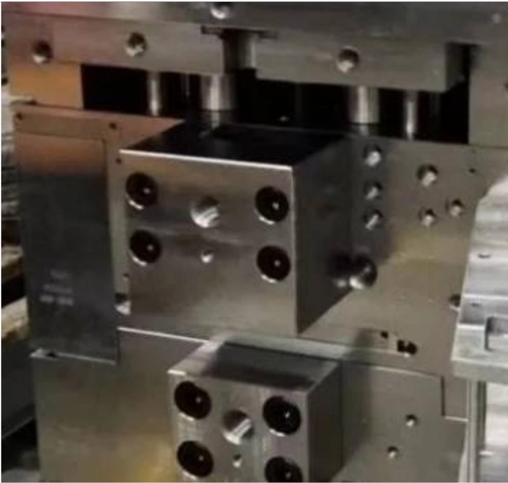
模具配件定位销零件是模具中的重要组成部分，它们处于重要的定位和固定作用。一个好的定位销设计可以确保模具装配的准确性，提高生产效率。
